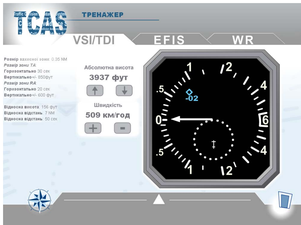
Рисунок 4.4. Інтерфейс дисплея VSI/TDI тренажру TCAS
