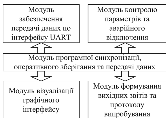
Рис. 9. Структура спеціалізованого програмного забезпечення комп'ютеризованого стенду
