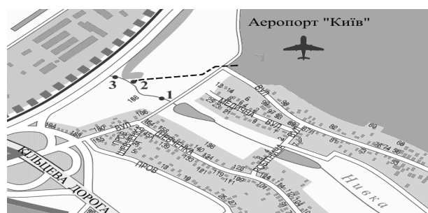
Рис. 1. Схема дослідження поверхневих, придонних вод та донних відкладів р. Нивка у районі скиду стічних вод авіапідприємств: 1 — до стоку, 2 — у місці стоку, 3 — після стоку
