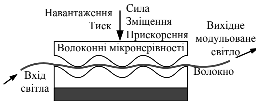
Рис. 7.30. Волоконнооптичний сенсор нерівностей
