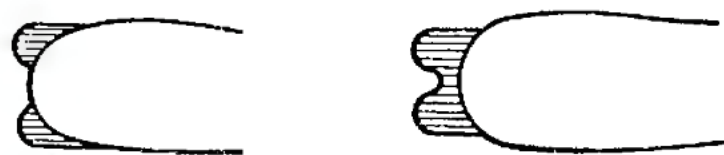
Рис. Д.1-3 (в). Відкладення льоду жолобкової форми [41]
