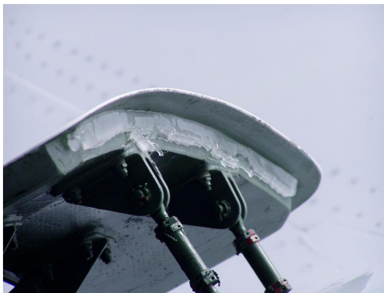
Рис. 1.2. Відкладення льоду, що перешкоджають закриттю люка [112]
