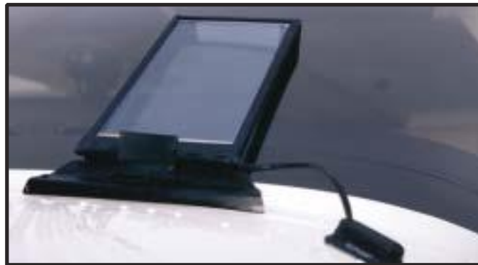
Рис. Д.1-15. Пристрій електричного обігріву вітрового скла [44]
