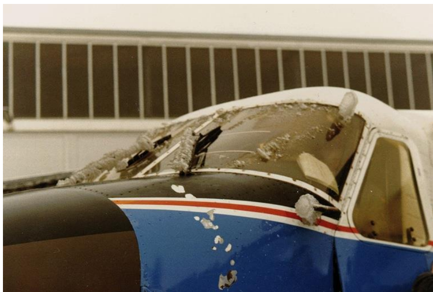
Рис. 1.1. Обледеніння кабіни пілотів, що погіршує оглядовість і ускладнює посадку [39]
