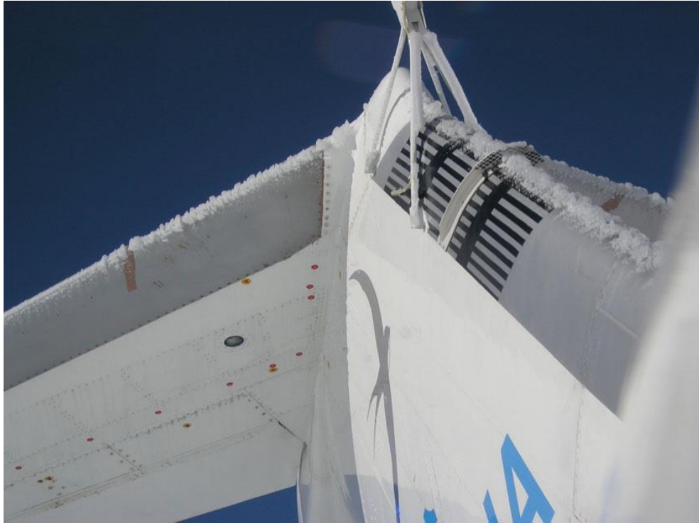
Рис. Д.1-2. Обледеніння на передній кромці кіля і стабілізатора літака АН-148 [112].
