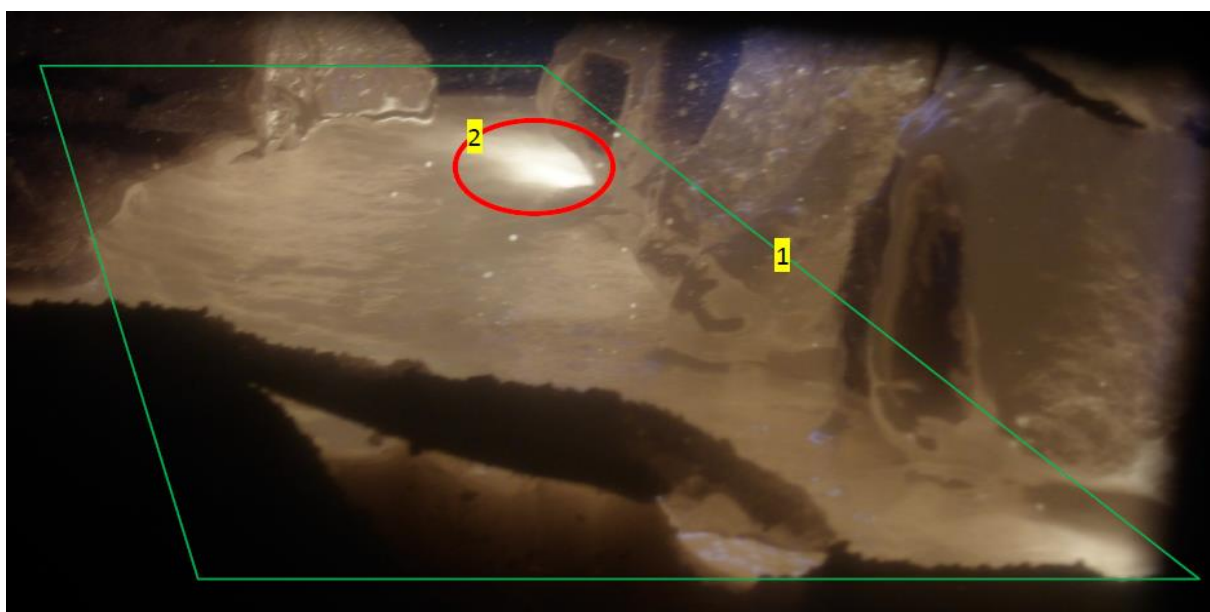
Рис. 3.2. Виділення області плавлення в ПС за допомогою програматора: 1 – виділена область ПС; 2 – область дії променю
