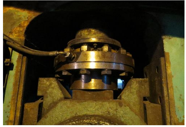
Рис. 4.3. Випробування ГММ (а) та їх його використання на валку прокатного стану (б)
