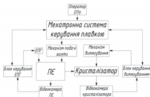
Рис. 8. Схема мехатронної системи керування ЕПП
