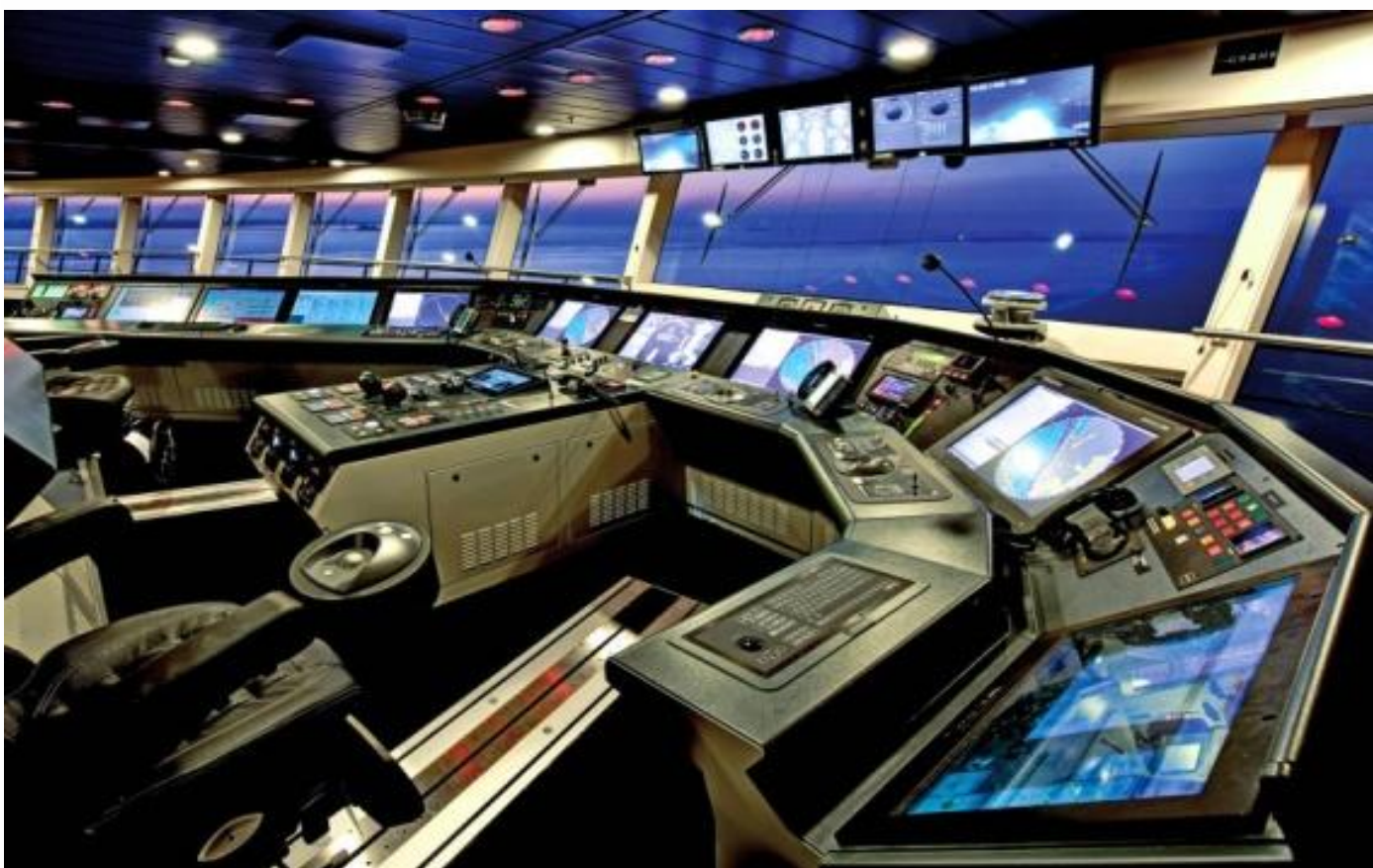
Рисунки 4.3 (а) та (б) – Компоновка обладнання навігаційного містка сучасного морського судна
