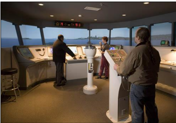
Рисунок 3.2 (а) – Відпрацювання вправ на повномасштабному повнофункціональному навігаційному тренажері з візуалізацією (BRM)
