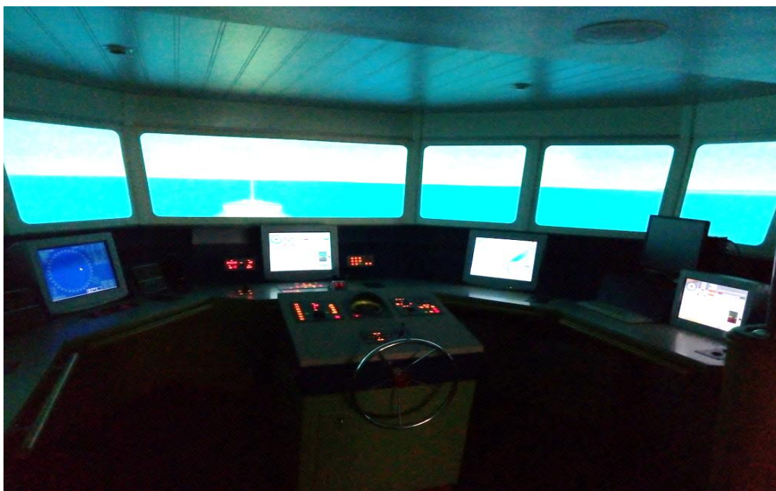
Рисунок 3.4 (а) – Навігаційний повномасштабний тренажер з візуалізацією Navi-Trainer NTPro-4000
