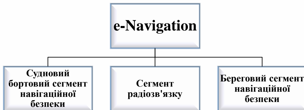
Рисунок 1.5 – Загальна конструкція системи "e-Navigation"
