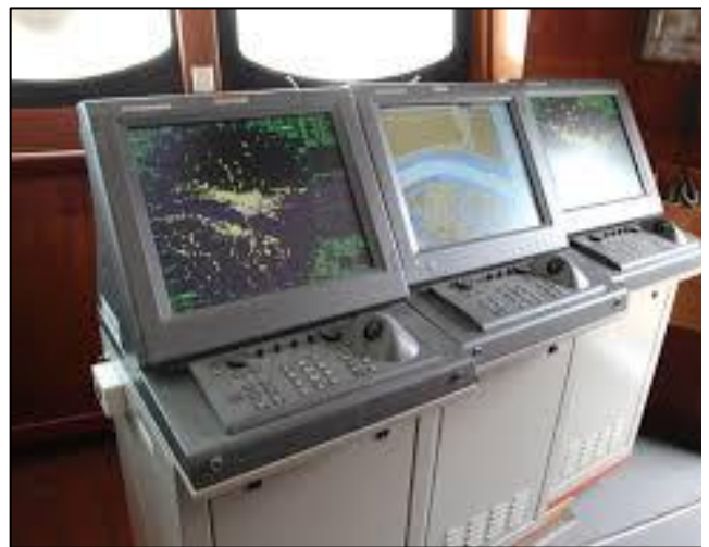
Рисунок 3.2 (б) – Тренажер з використання електронних картографічних та навігаційно-інформаційних систем (ECDIS)
