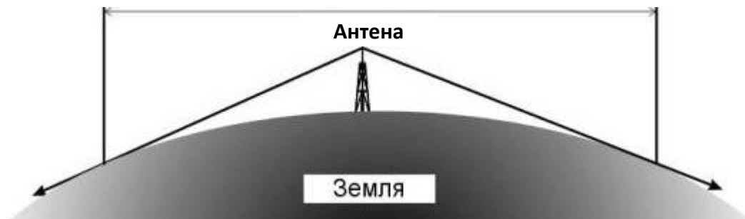
Рисунок 6.5 – Розповсюдження сигналів АІС в межах радіогоризонту
