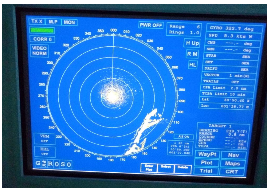
Рисунок 3.4 (б) – Радіолокаційне відображення навігаційної обстановки на тренажері під час моделювання поведінки судноводіїв та методів керування ВТЗ
