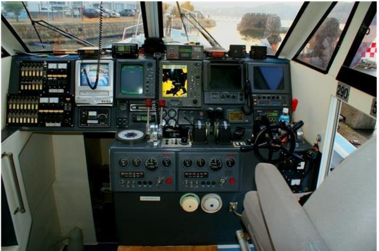
Рисунок 4.3 (в) – Компонівка обладнання навігаційного містка сучасного морського катера
