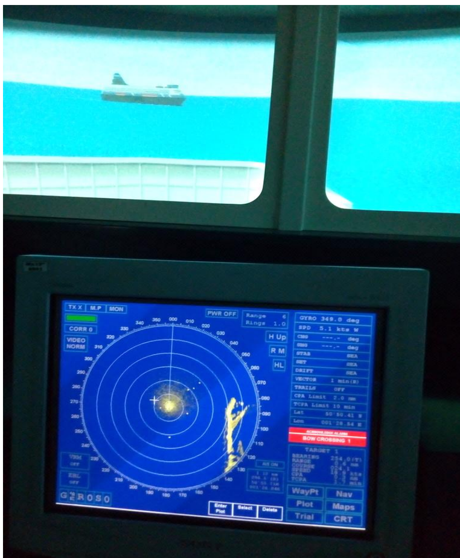
Рисунок 3.4 (в) – Приклад небезпечного наближення з іншим ВТЗ під час моделювання поведінки судноводіїв та методів керування ВТЗ при введенні інструктором додаткових ввідних, при якому на тренажері спрацьовує візуальна та звукова сигналізація
