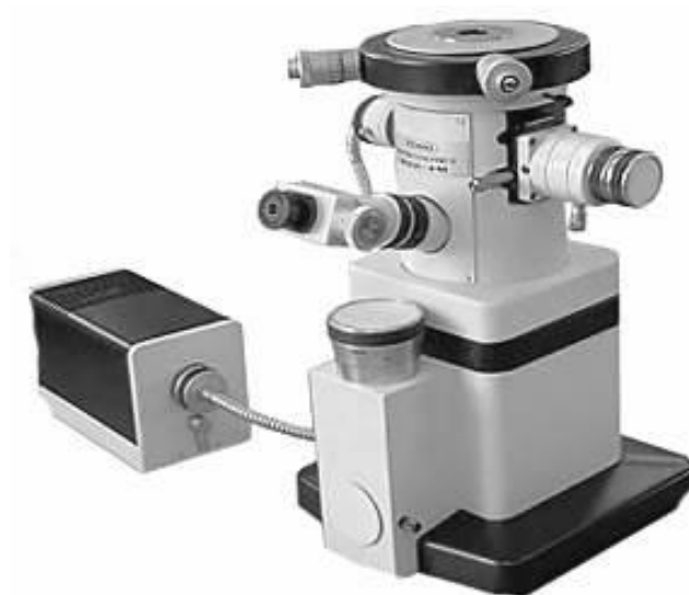
Рис. 2.3. Загальний вигляд мікроінтерферометра «МП-4»
