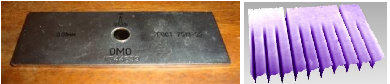
Рис. 3.24. Об'єкт-мікрометр ( a ) та його ділянка у 3D зображенні ( б )
