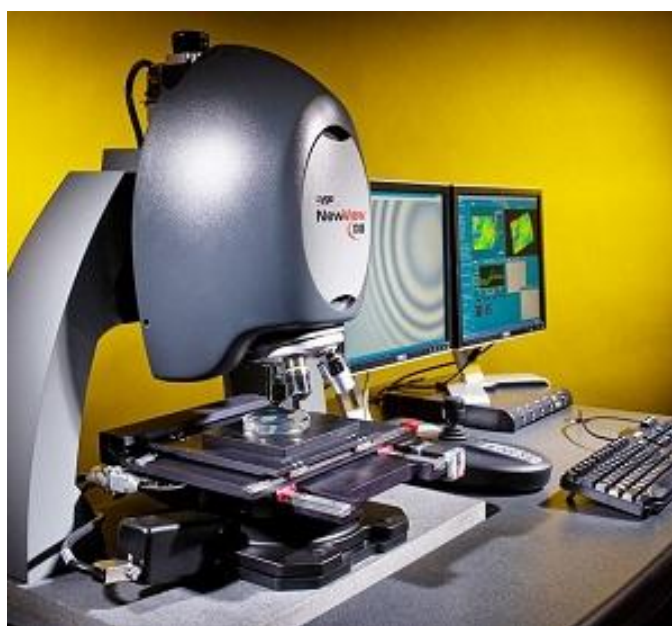
Рис.1.8. Загальний вигляд інтерференційного профілометра NewView 6300
