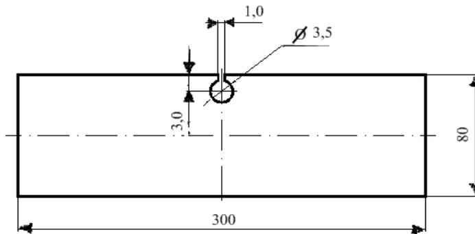
Рис. 1. Образец для мониторинга локальной поврежденности и трещины.
