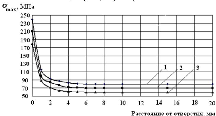
Рис.3. Распределение напряжений вблизи концентратора:
