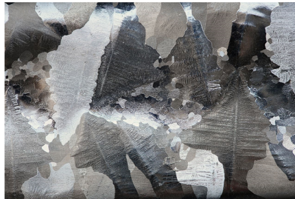
Микроструктура алюминия на протравленной поверхности слитка, чистотой 99,9998 %,
