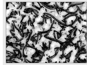
Структура серого чугуна, x100
