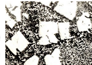
Микроструктура заэвтектического сплава «свинец-сурьма», \times 250 (Pb – 70%, Sb – 30%)
