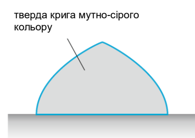
Рисунок 2 – Мимовільний процес замерзання переохолодженої поверхневої краплі: а) - в) – перша фаза, утворення «хмарної», розподіленої за об'ємом структури крига-вода; г) - е) – друга фаза, затвердіння краплі з боку пластини, наявність чіткої межі розподілу фаз
