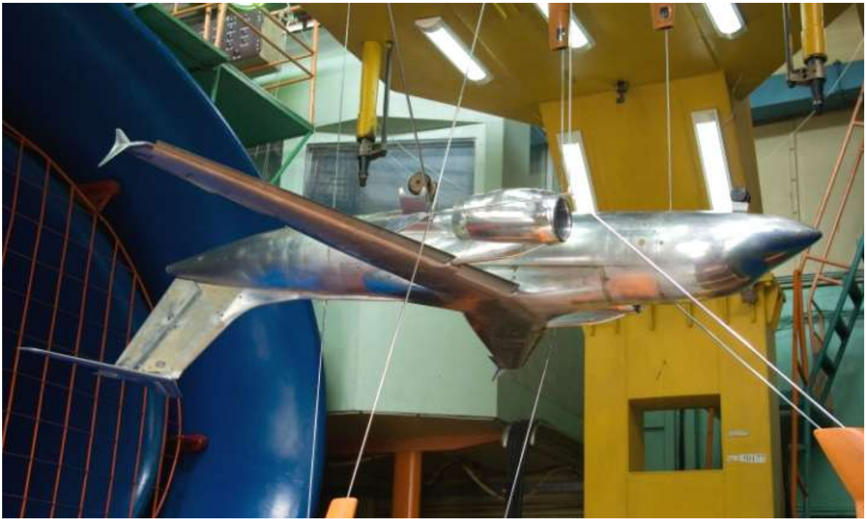
Рисунок 3.8 – Механізована модель літака Ан-158 в аеродинамічній трубі АТ-1
