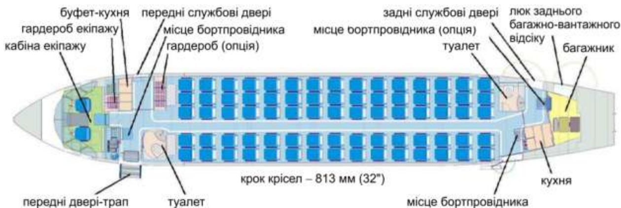
Рисунок 2.11 – Схема компонування салону літака на 75 пасажирів
