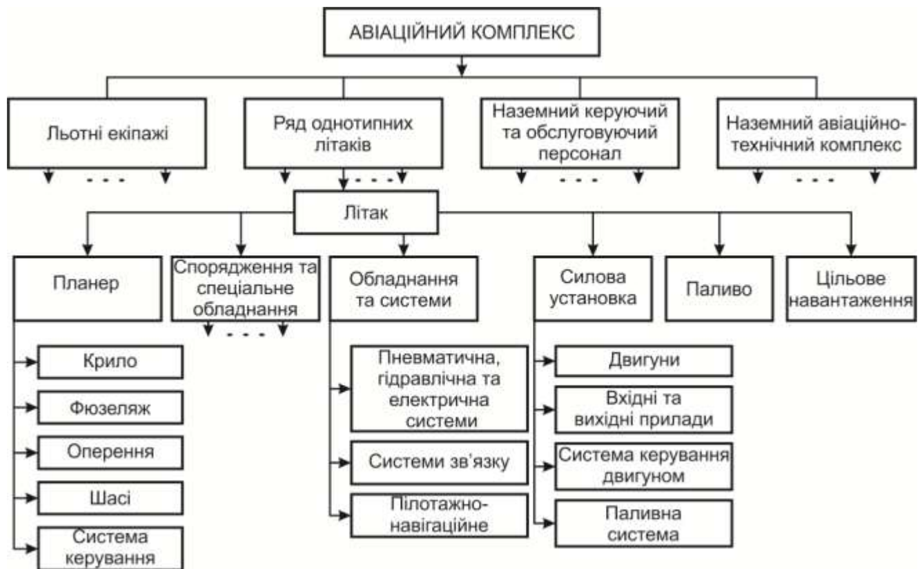
Рисунок 1.1 – Функціонально-структурна схема авіаційного комплексу
