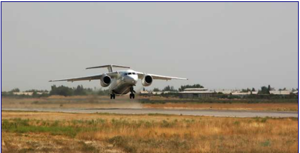
Рисунок 4.11 – Випробування за високих температур (до +45\text{ }^{\circ}\text{C} ) і в умовах високогір'я (висота аеродромів до 4100 м). Гюмрі (Вірменія), Карші (Узбекистан), Іран, Ла-Паз (Болівія)
