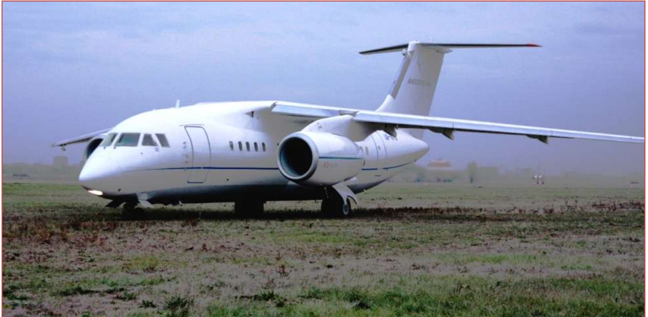
Рисунок 4.12 – Випробування на ґрунтовій злітній смузі
