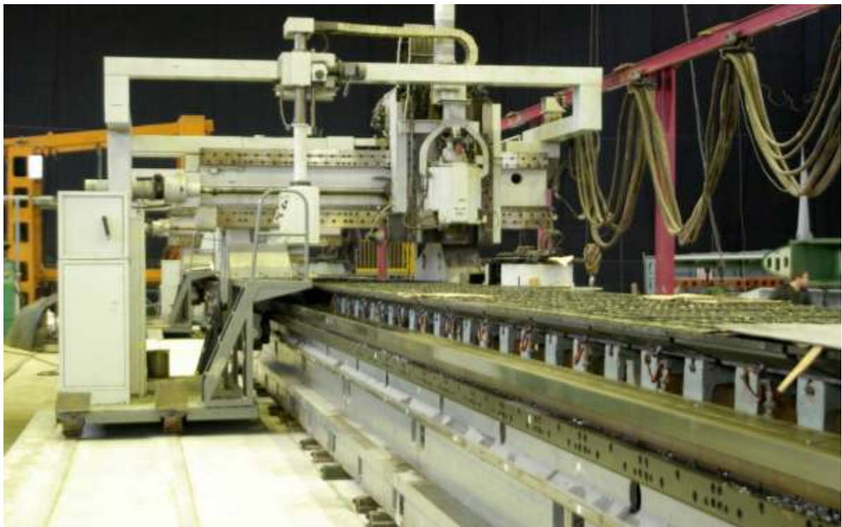
Рисунок 4.5 – Фрезерний верстат із ЧПК для виготовлення довгомірних деталей крила
