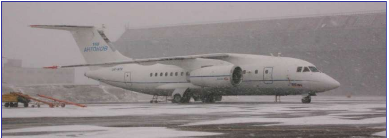
Рисунок 4.14 – Випробування літака в умовах природного зледеніння за температур до -20\text{ }^{\circ}\text{C} (Архангельськ, Нарьян-Мар (Росія))
