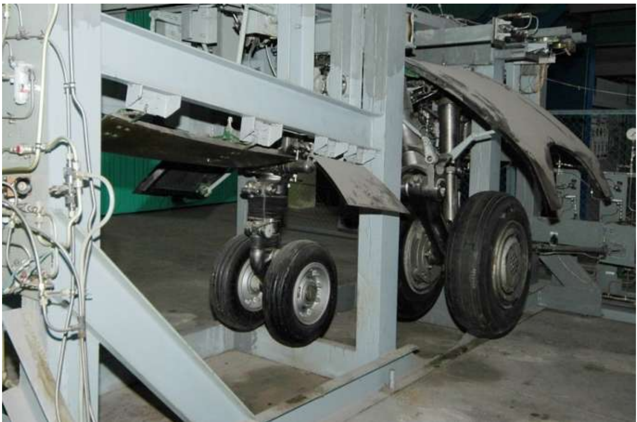
Рисунок 4.13 – Стенди дослідження роботи шасі літака
