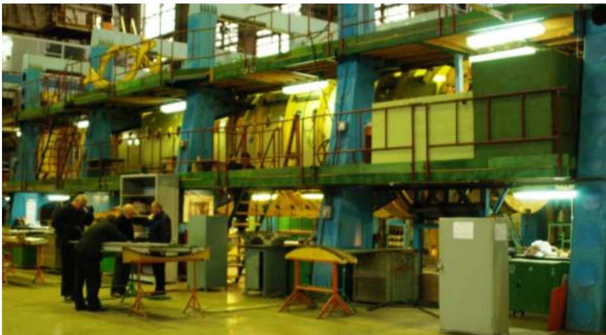
Рисунок 4.2 – Стапель складання та стикування агрегатів фюзеляжу
