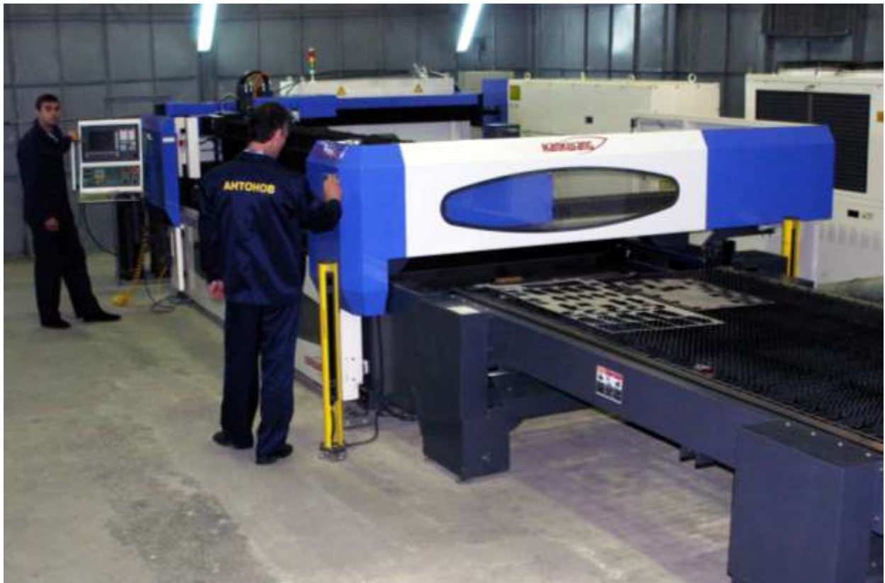
Рисунок 4.3 – Дільниця лазерного розкрою матеріалів
