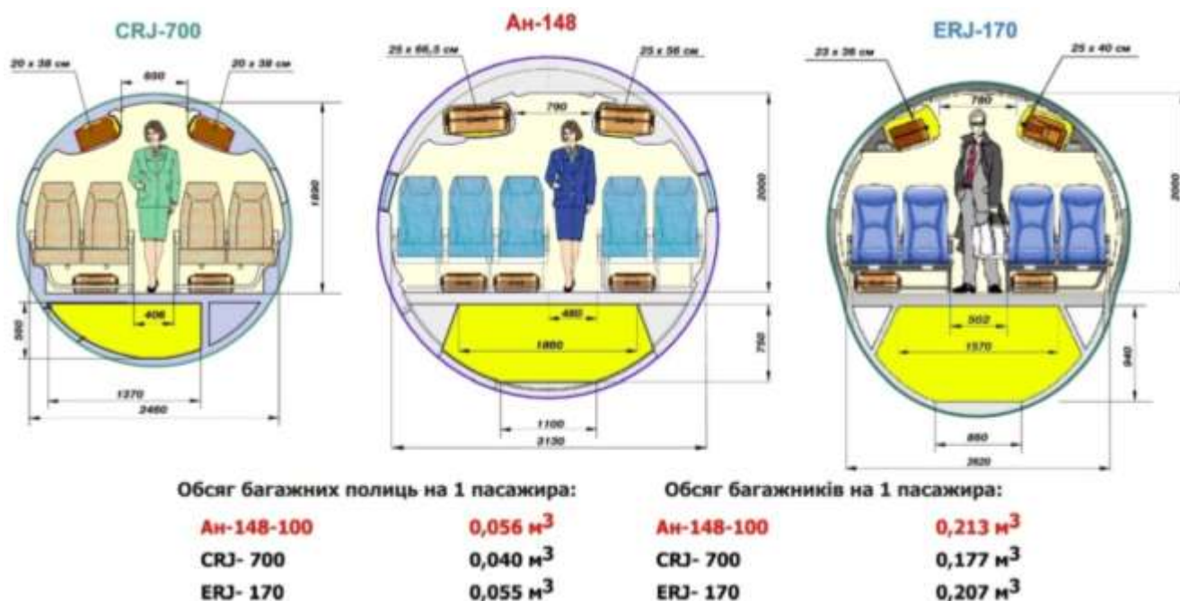
Рисунок 2.12 – Порівняння поперечних перерізів фюзеляжів літака Ан-148-100 та його аналогів
