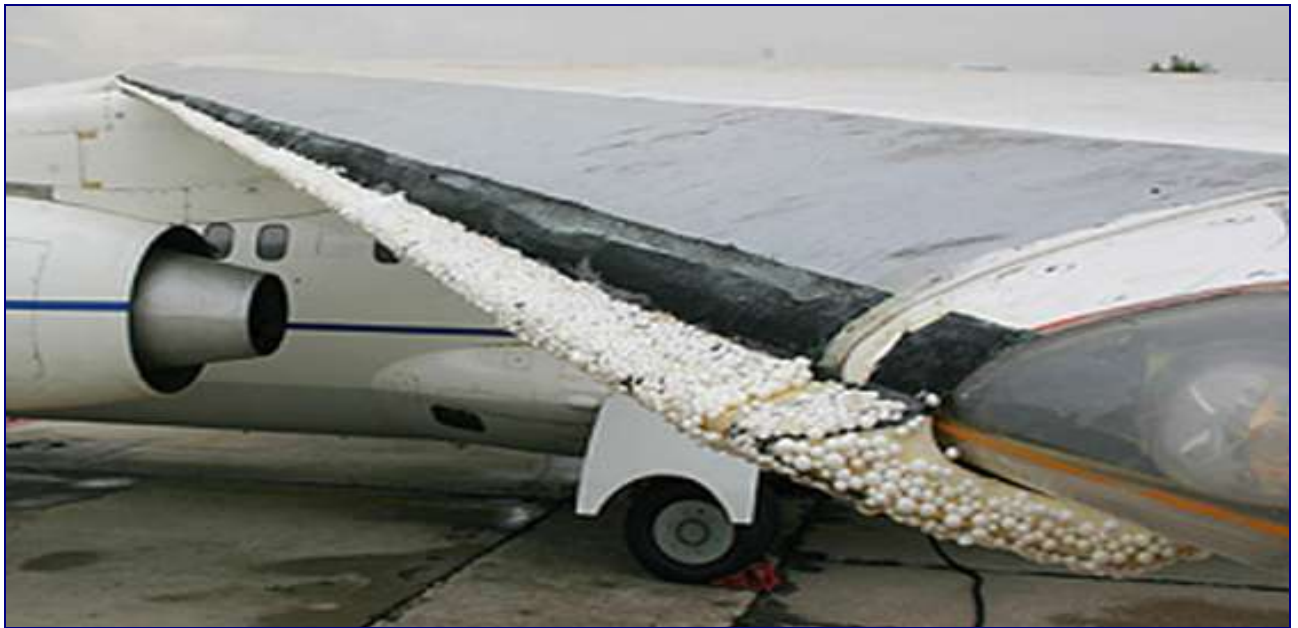
Рисунок 4.16 – Льотні випробування з імітаторами льоду
