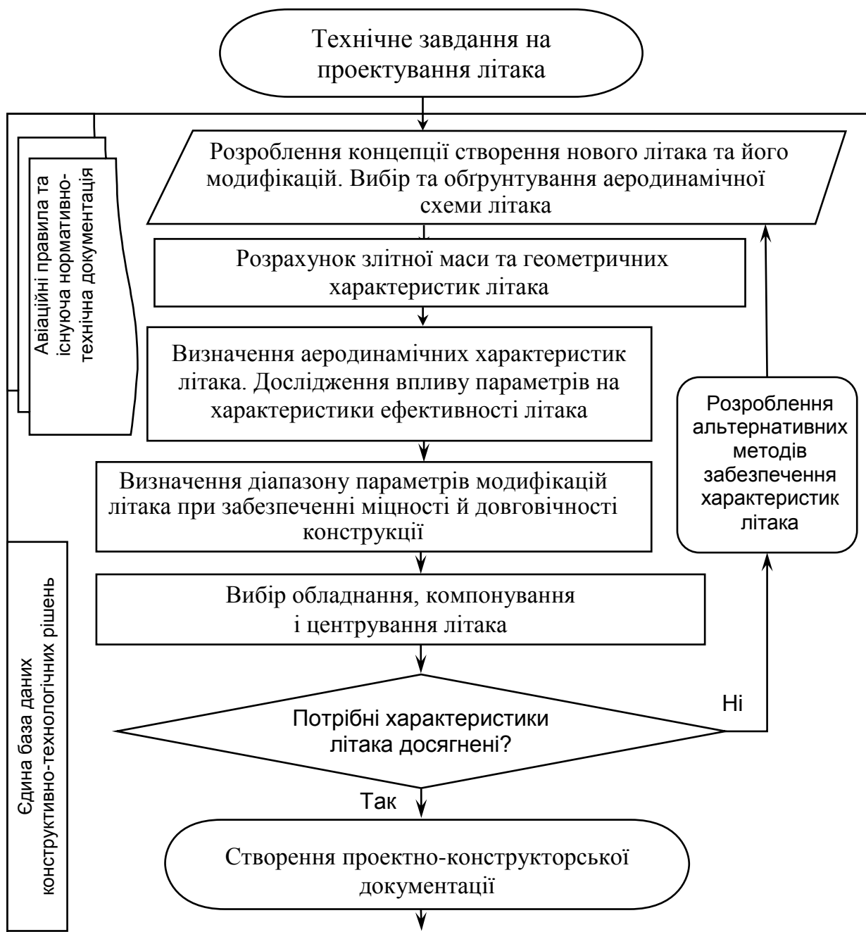
Рисунок 2.4 – Блок-схема методу загального проектування регіональних пасажирських літаків
