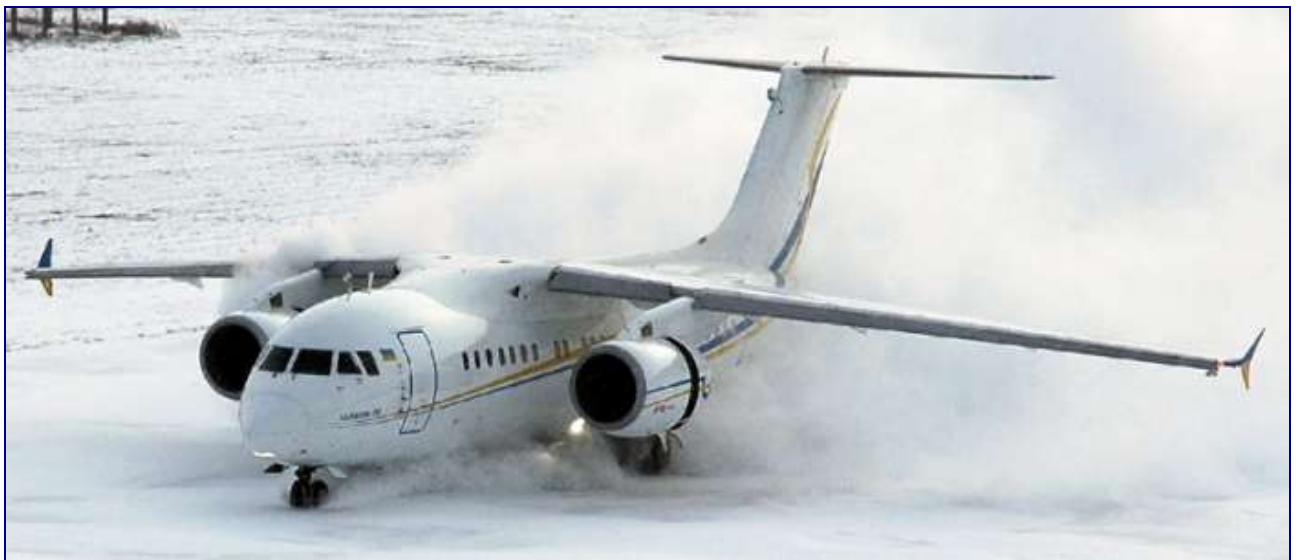
Рисунок 4.17 – Льотні випробування на ЗПС, покритих опадами
