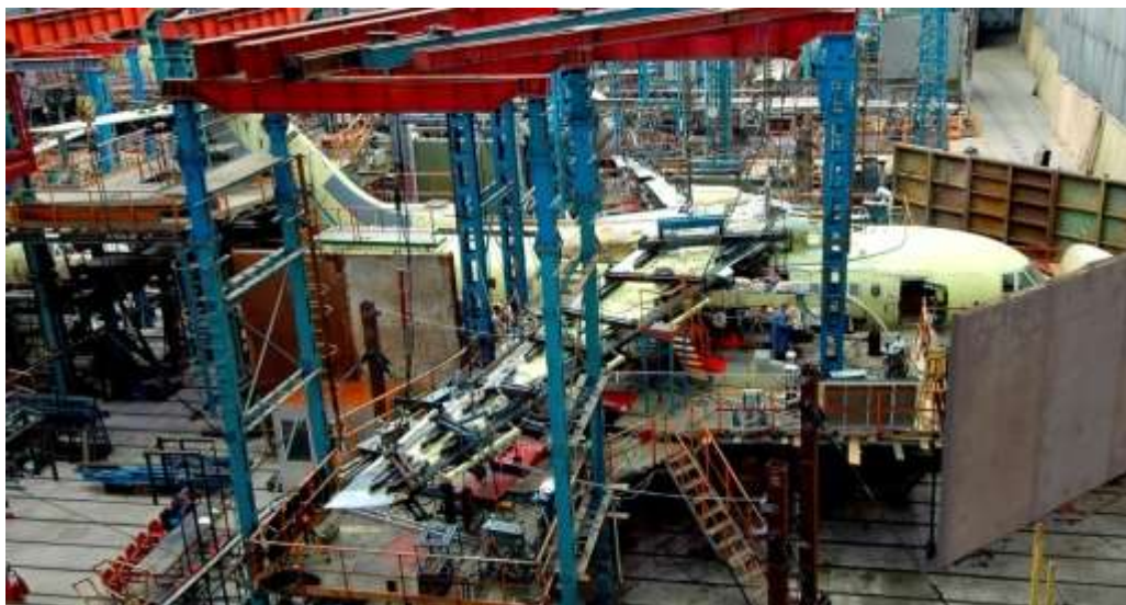
Рисунок 3.34 – Стенд для проведення статичних і ресурсних досліджень планера літака
