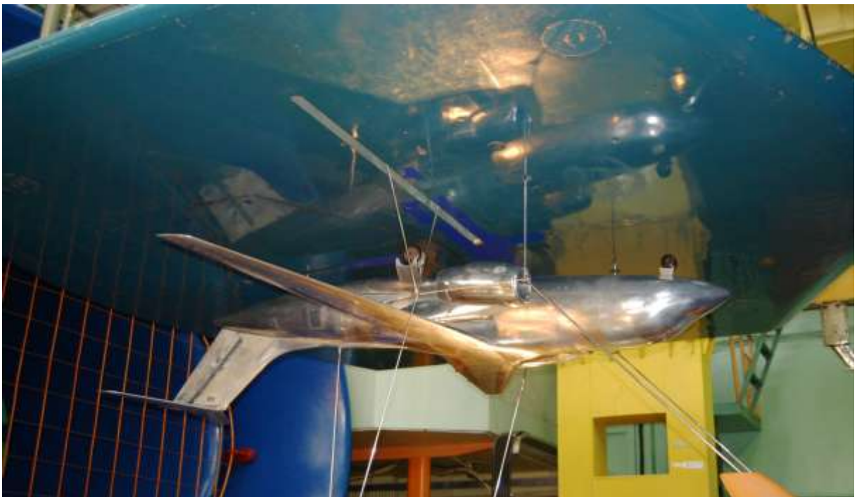
Рисунок 3.9 – Модель літака Ан-148 поблизу екрана в аеродинамічній трубі АТ-1
