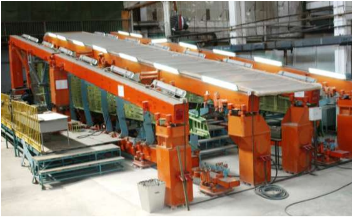
Рисунок 4.7 – Загальний вигляд стапеля складання кесонів крила
