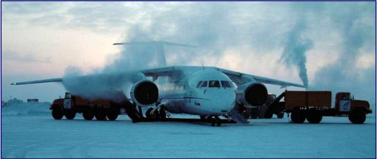
Рисунок 4.10 – Випробування за наднизьких температур (до -55\text{ }^{\circ}\text{C} ). Якутськ, Нерюнґрі (Росія)
