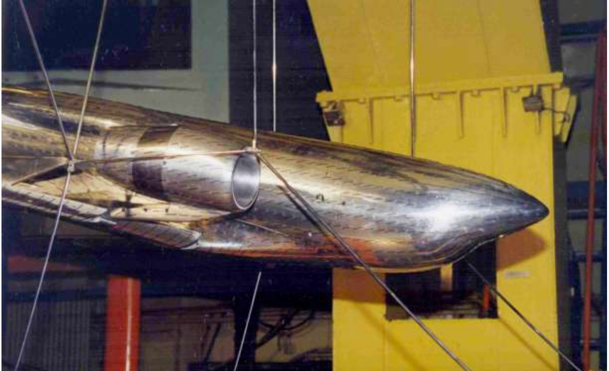
Рисунок 3.6 – Візуальні випробування моделі літака Ан-148 методом шовковинок в аеродинамічній трубі АТ-1
