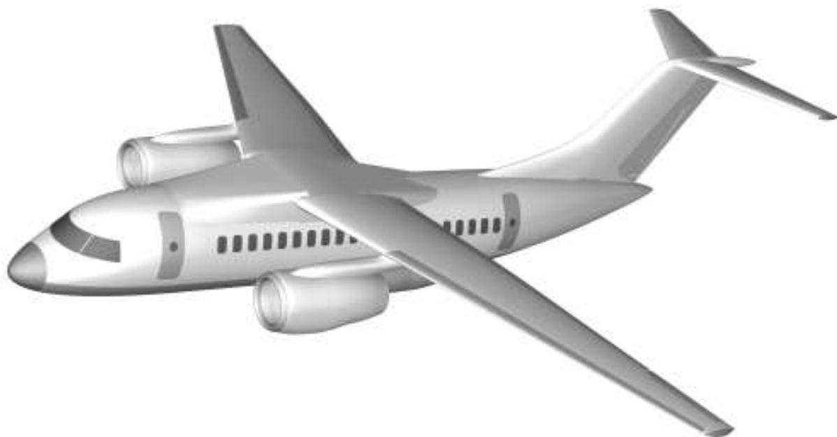
Рисунок 3.13 – Майстер-геометрія регіонального пасажирського літака
