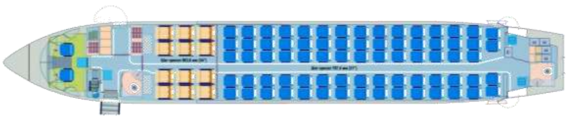
Рисунок 3.23 – Компонування літака Ан-158 на 86 пасажирів у двокласному компонуванні
