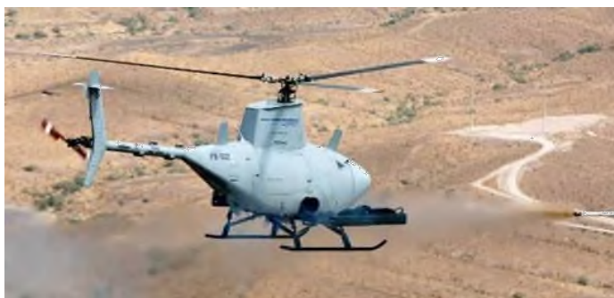
Рис.1.5. Приклад безпілотного вертоліту, побудованого по одногвинтовій схемі з хвостовим рульовим гвинтом – RQ-8A Fire Scout.
