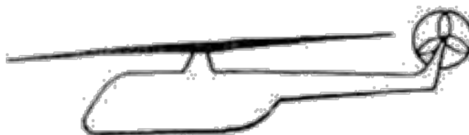
Рис.1.4. Класична одногвинтова схема с хвостовим рульовим гвинтом
