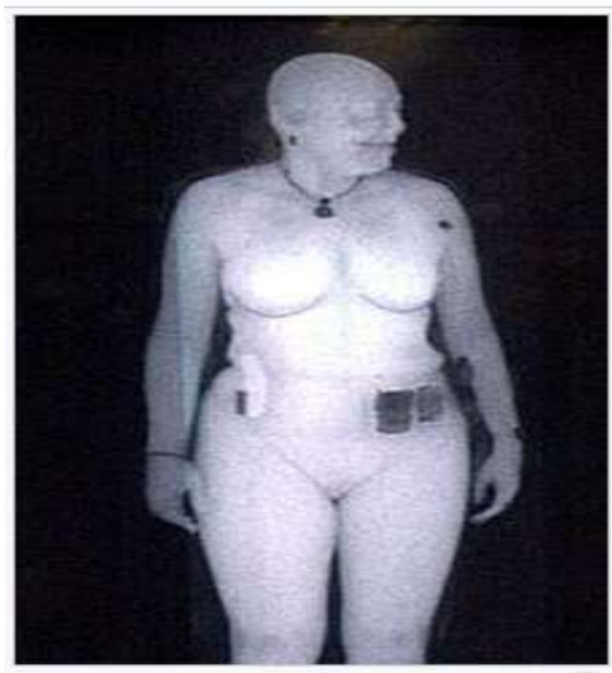
Рис.1.2. Зображення, отримане сканером на основі зворотного розсіювання. Зображення Susan Hallowell - директора лабораторії з Transportation Security Administration
