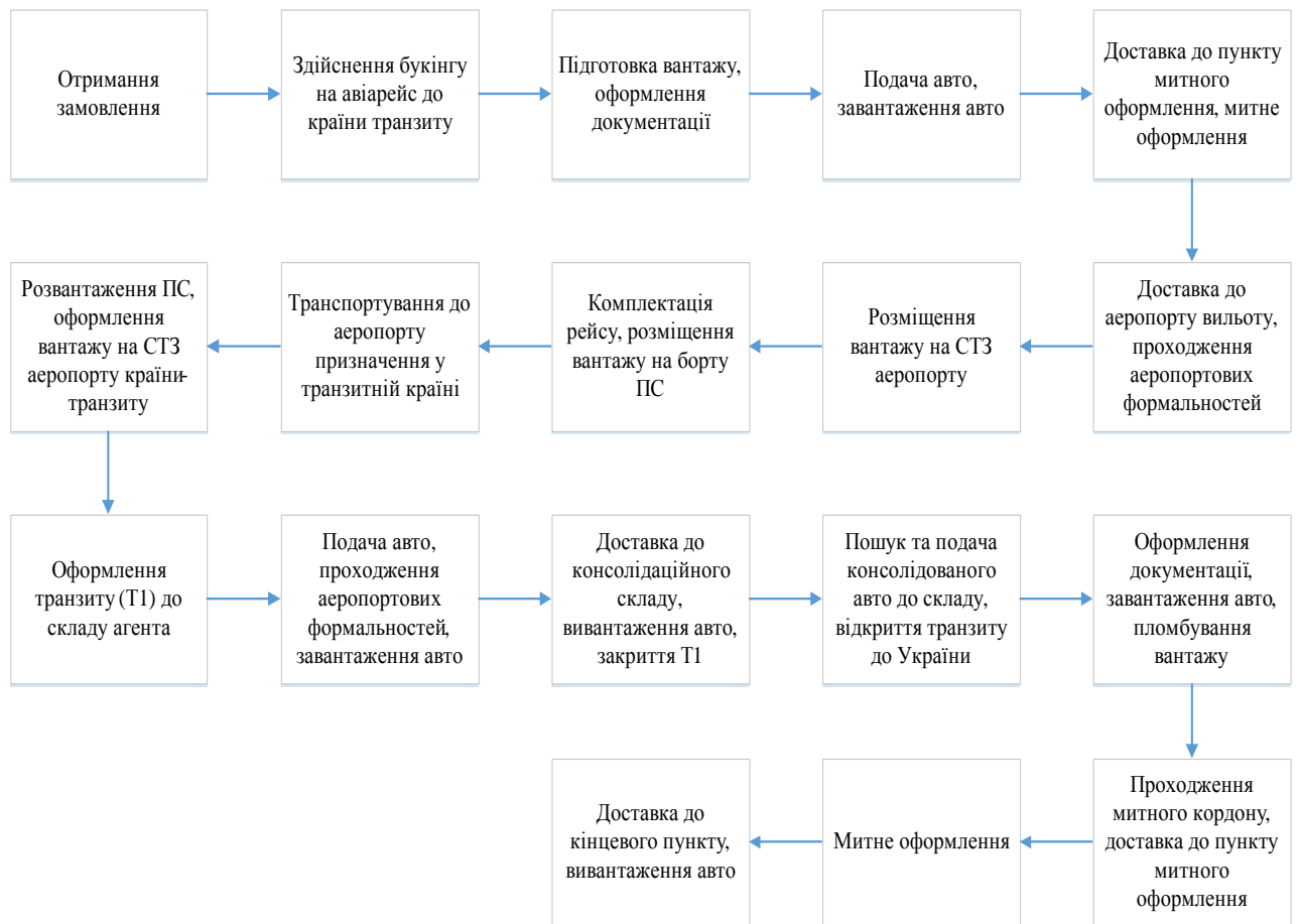
Рис. 3.4. Запропонована транспортно-технологічна схема доставки вантажів за участю авіаційного транспорту
