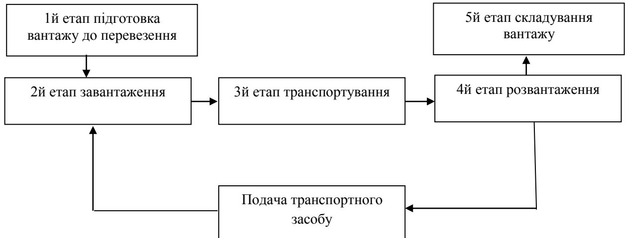
Рис. 1.1. Технологічна схема процесу перевезення вантажів одним видом транспорту
