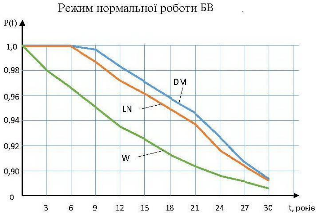
Рис. 5.5. Імовірність безвідмовної роботи БВ в перші 30 років експлуатації в режимі нормальної роботи (DM – дифузійне монотонне розподілення; LN – логарифмічне нормальне розподілення; W – розподілення Вейбулла)
