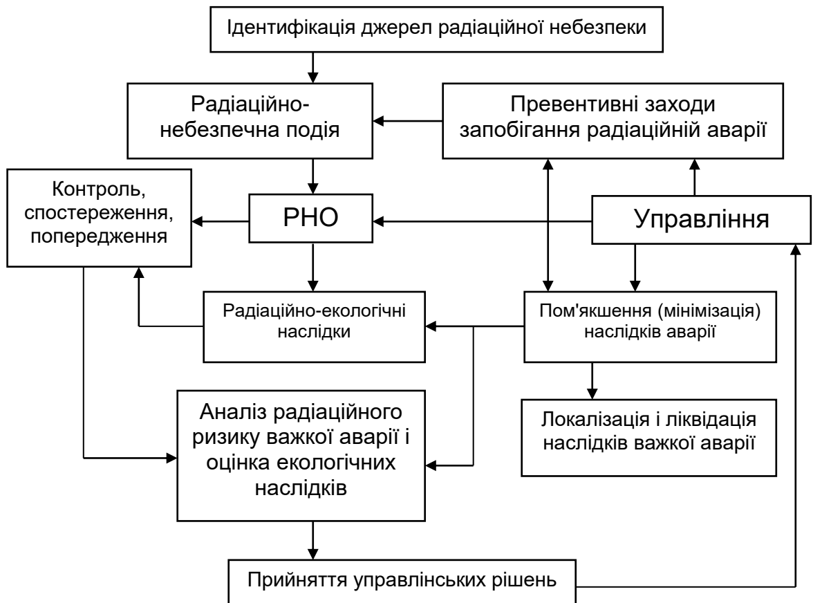
Рис. 7.9. Структурна схема контролю і керування важкими радіаційними аваріями
