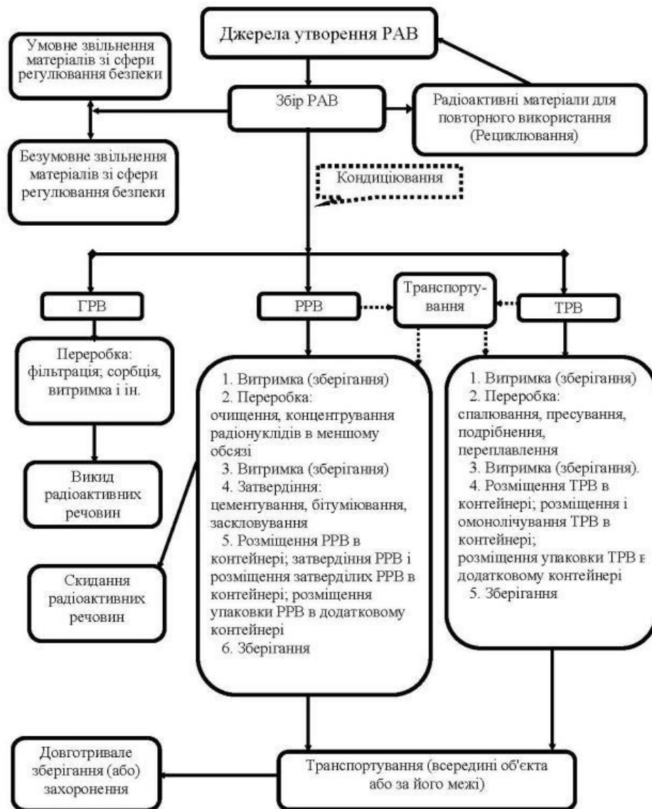
Рис. 5.11. Концептуальна модель системи безпечного поводження з РАВ
