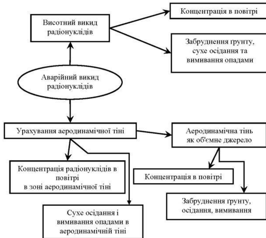
Рис. 3.2. Блок-схема організації розрахунків характеристик забруднення повітря і ґрунту під час аварійного викиду РПЗ і пилу
