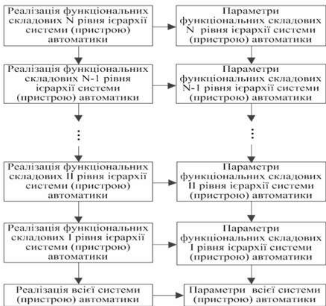
Рисунок 6.3 – Каузальний ланцюг знань при проектуванні реалізації та визначенні показників функціонування системи (пристрою) автоматики об'єкту (елементу) енергосистеми
