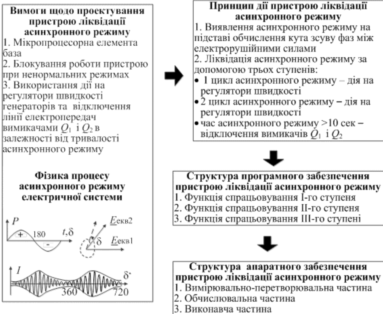
Рисунок 6.6 – Каузальний ланцюг знань з визначення принципу дії, структури програмного та апаратного забезпечення пристрою ліквідації асинхронного режиму
