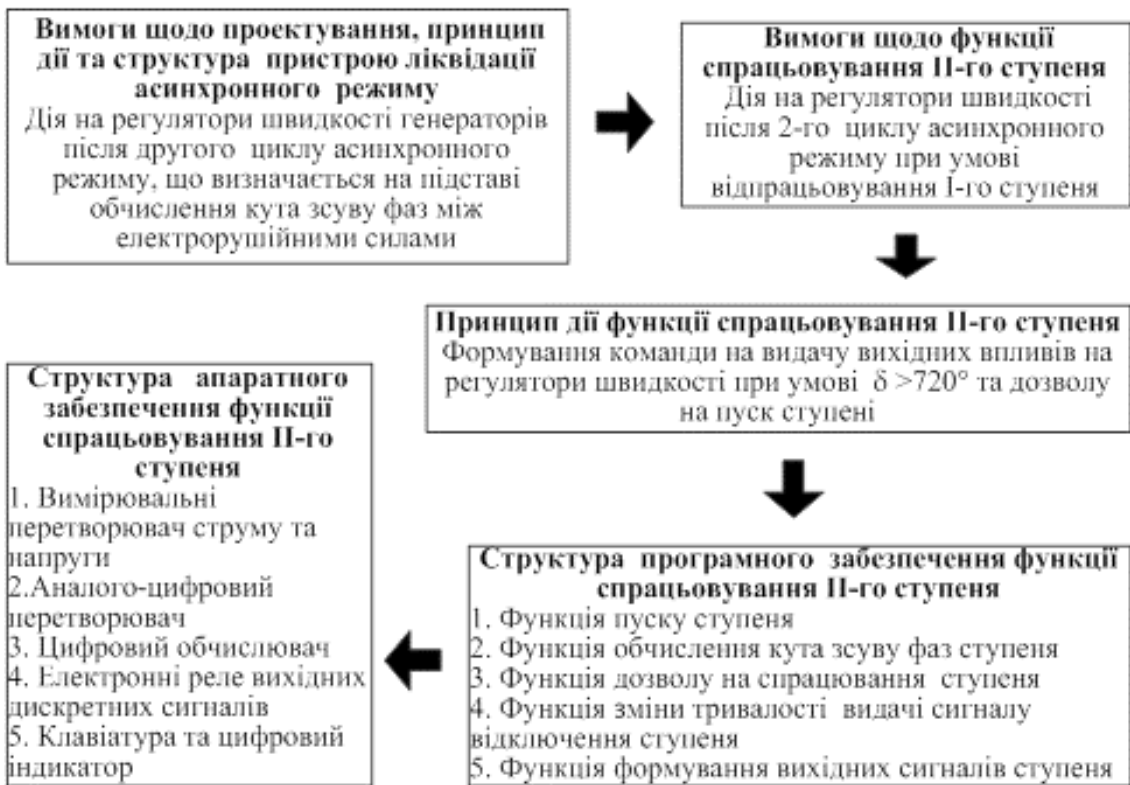
Рисунок 6.8 – Каузальний ланцюг знань з визначення вимог щодо проектування, принципу дії й структури програмного та апаратного забезпечення функції спрацьовування II-го ступеня пристрою
