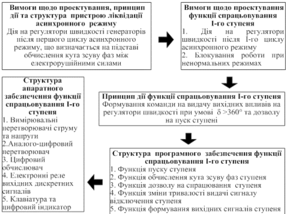
Рисунок 6.7 – Каузальний ланцюг знань з визначення вимог щодо проектування, принципу дії й структури програмного та апаратного забезпечення функції спрацьовування I-го ступеня пристрою
