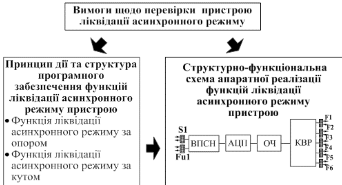
Рисунок 6.23 – Каузальний ланцюг знань з визначення принципу дії та побудови функцій ліквідації асинхронного режиму пристрою
