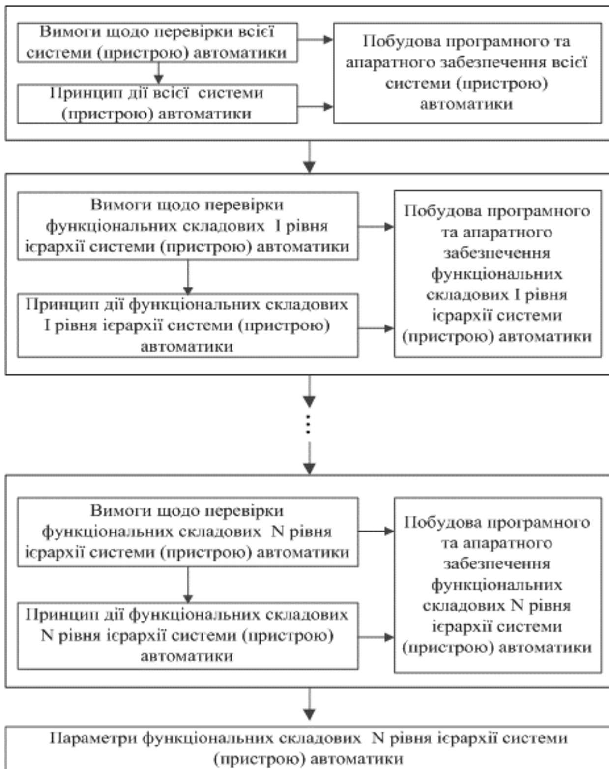
Рисунок 6.18 – Каузальний ланцюг знань при розробленні завдання на технічну перевірку, перевірки технічного стану та встановлення показників функціонування складових I-N рівнів ієрархії системи (пристрою) автоматики об'єкту (елементу) енергосистеми
