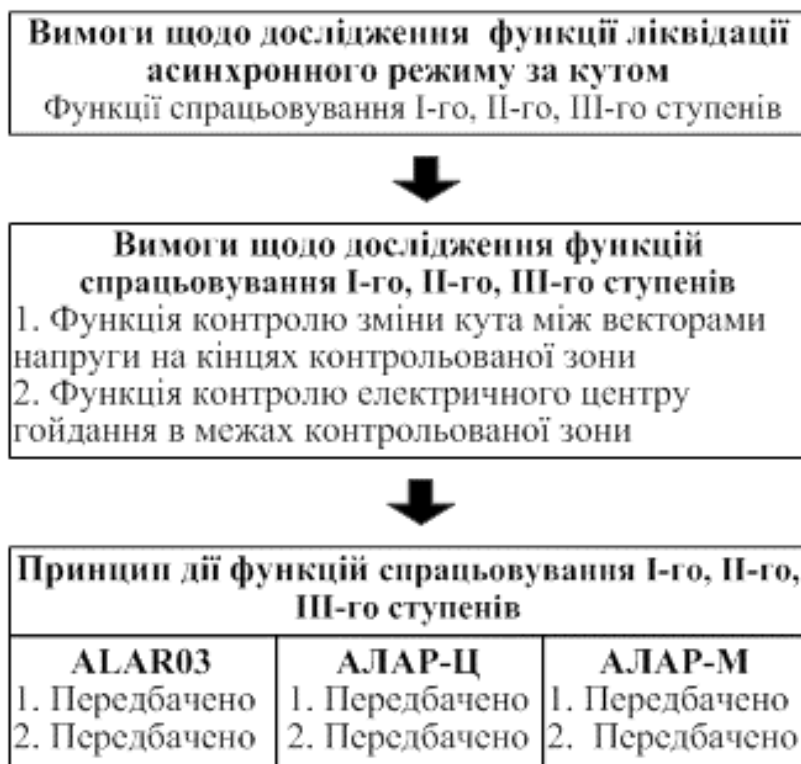
Рисунок 6.38 – Каузальний ланцюг знань з визначення вимог щодо дослідження та принципу дії функцій спрацьовування I-го, II-го, III-го ступенів в пристроях ALAR03, АЛАР-М, АЛАР-Ц
