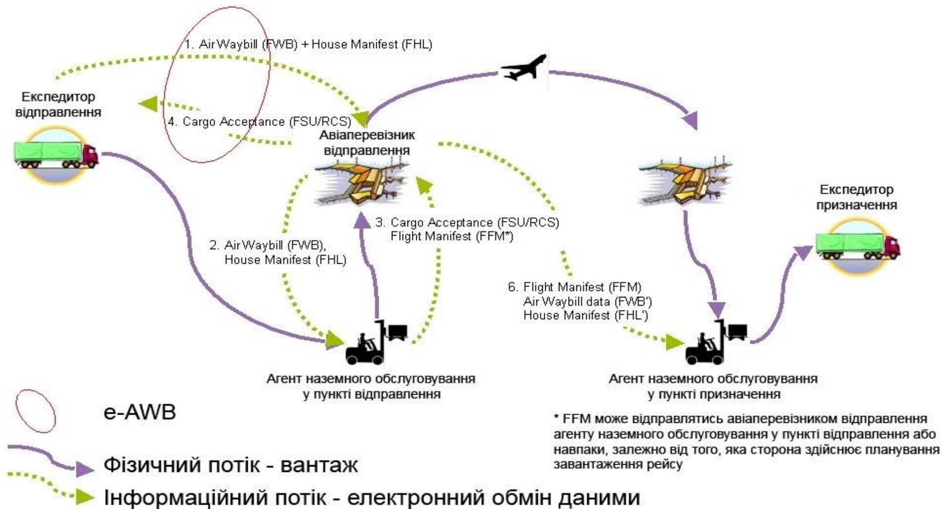
Рис. 1.5. Схема електронного обміну даними між агентами наземного обслуговування, авіакомпаніями та експедиторами за умови, що авіаперевізник має офіс лише у пункті відправлення
