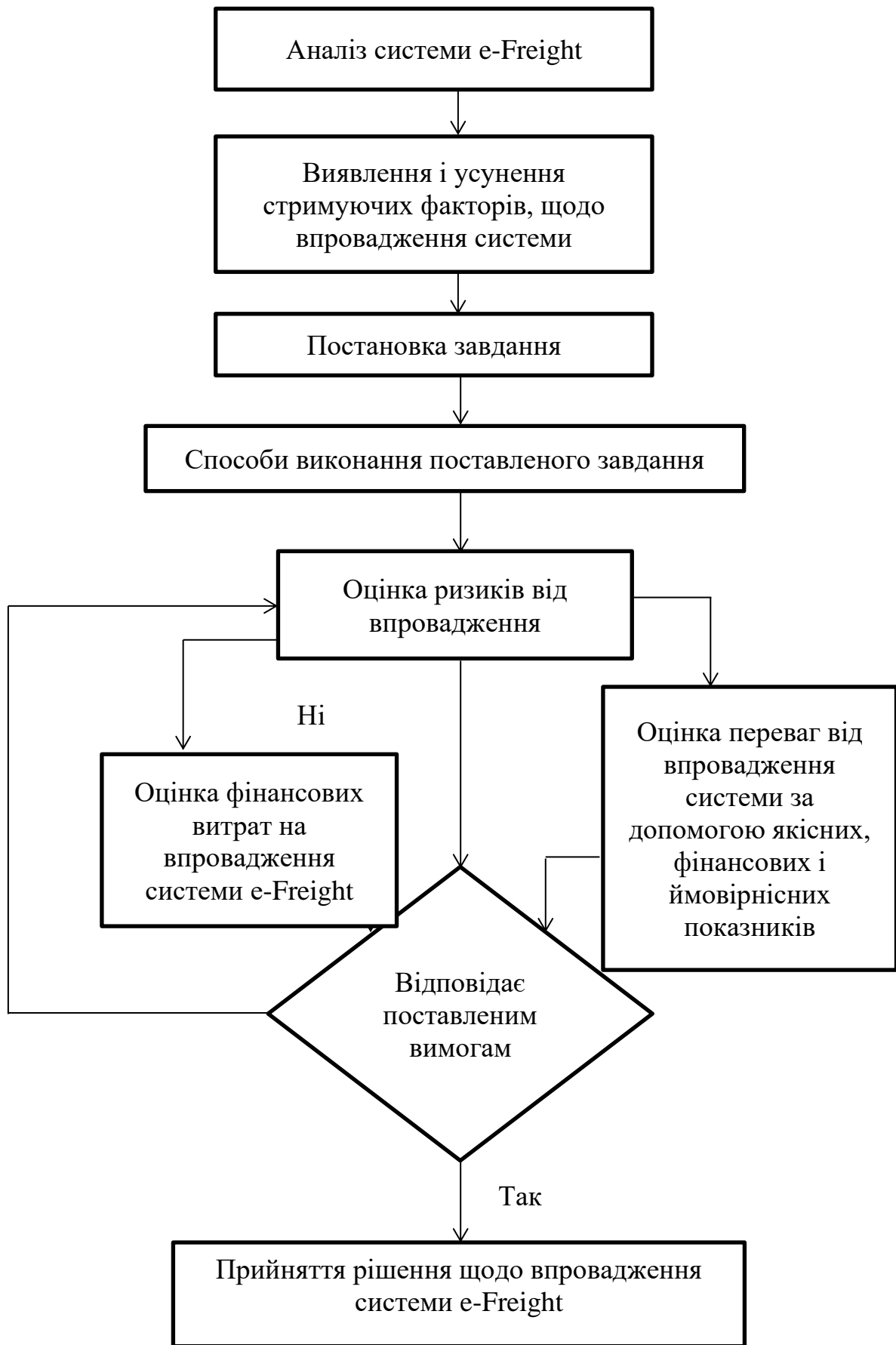
Рис. 1.8. Алгоритм прийняття рішення щодо впровадження системи IATA e-Freight
