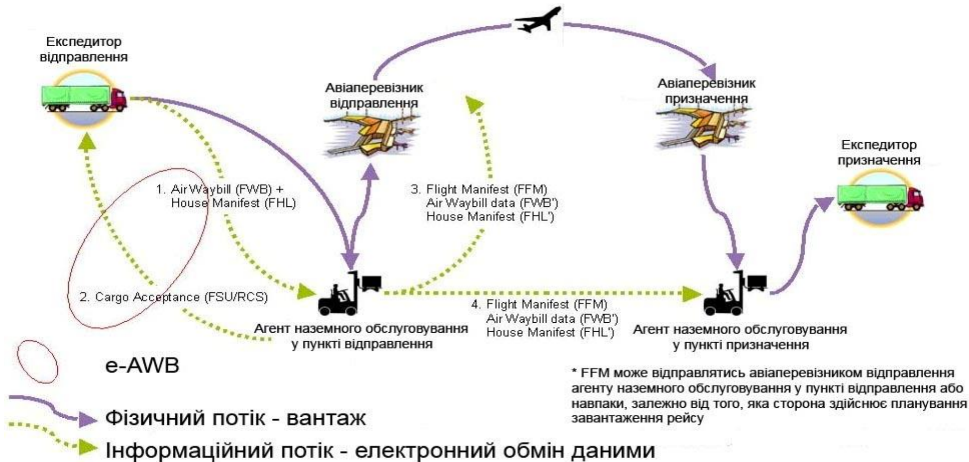
Рис. 1.7. Схема електронного обміну даними між агентами наземного обслуговування, авіакомпаніями та експедиторами, за умови, що агент наземного обслуговування у пункті відправлення отримує інформацію від експедитора відправлення та надсилає інформацію авіаперевізнику в пункті відправлення та агенту наземного обслуговування в пункті призначення
