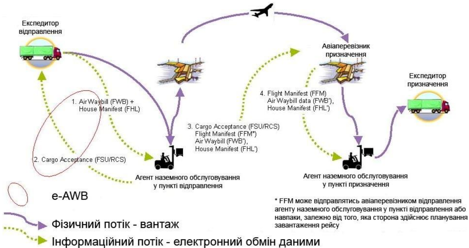
Рис. 1.6. Схема електронного обміну даними між агентами наземного обслуговування, авіакомпаніями та експедиторами за умови, що авіаперевізнак має офіс лише у пункті призначення
