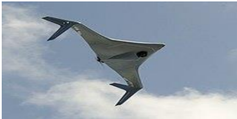
Рис.1.2 Зовнішній вигляд БПЛА типу Northrop Grumman Bat з датчиками EO / IR і SAR, лазерними далекомірами, лазерними вказівками, інфрачервоними камерами
