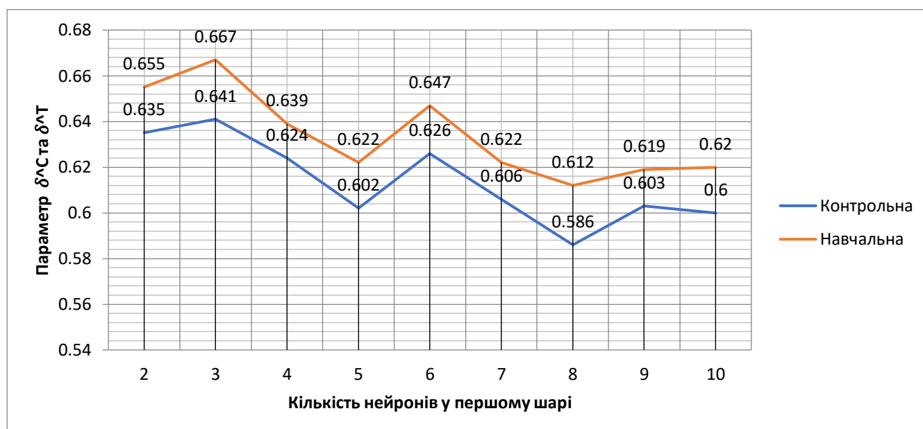
Рис. 3.7. Значення параметрів \delta^T та \delta^C в залежності від кількості нейронів (II навчання)
