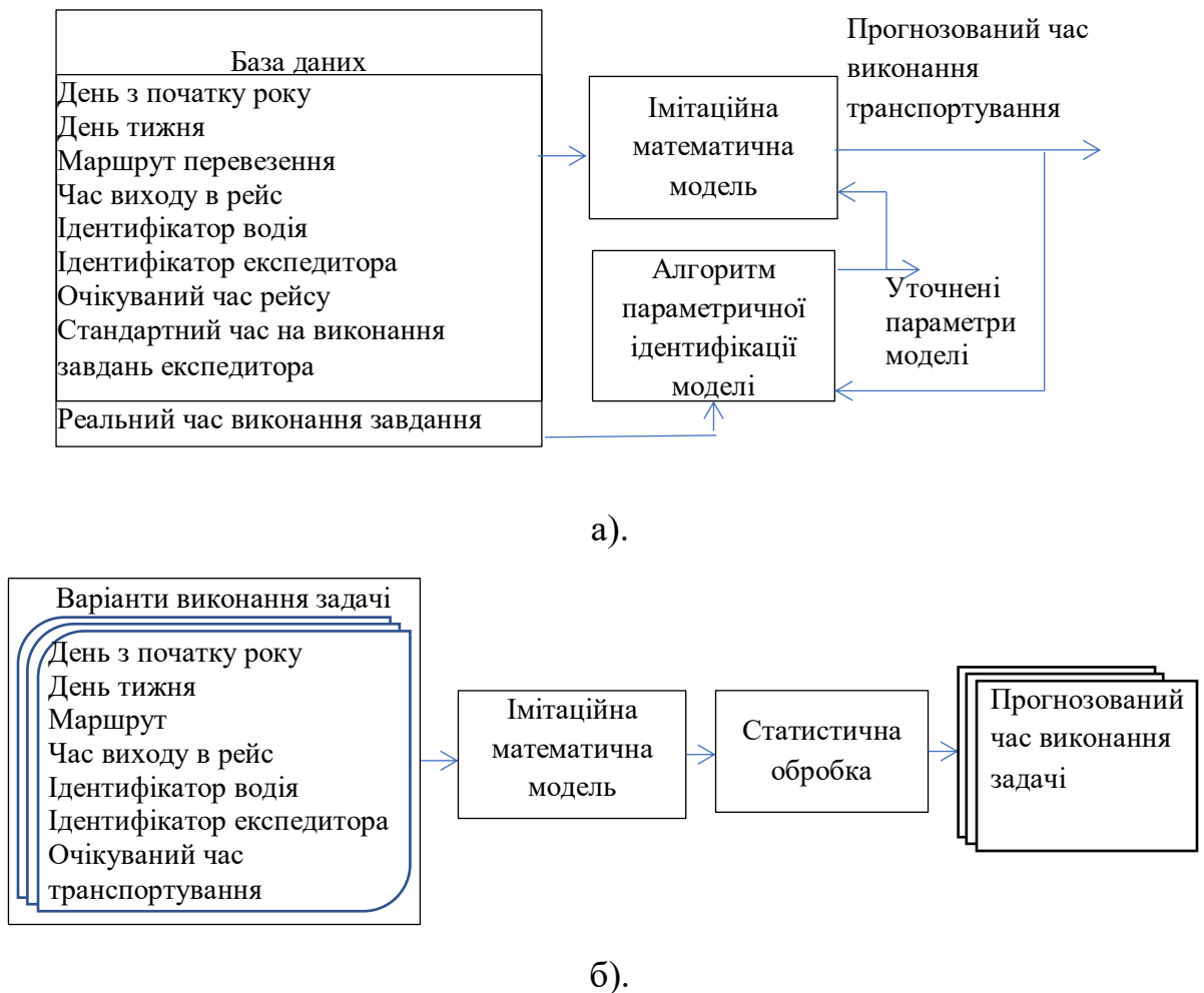
Рис. 3.1. Схема обробки інформації в інтелектуальній системі підтримки прийняття рішень: а). – процес ідентифікації математичної моделі; б). – оптимізація процесу виконання конкретної задачі
