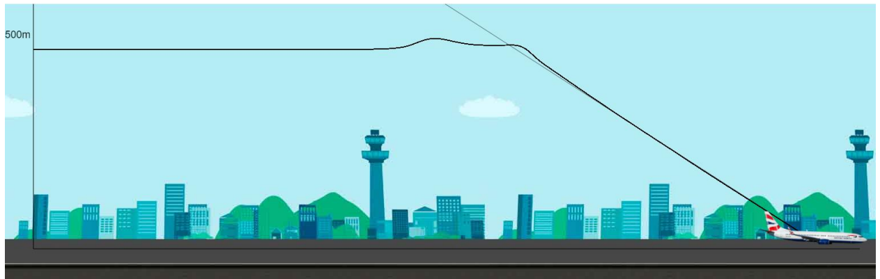
Рис. 4.7. Динаміка заходу літака на посадку при значенні значенні кута залягання глісади 4^\circ
