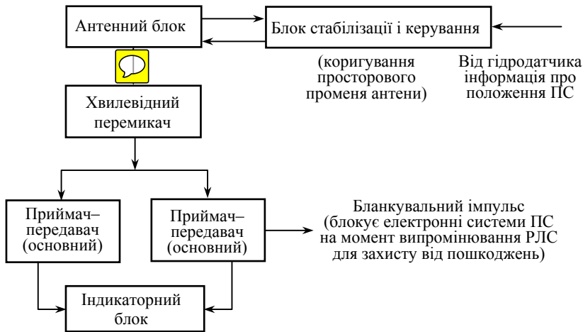
Рис. 5.2. Узагальнена схема МНРЛС другого покоління
