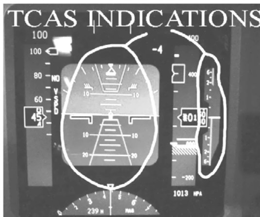
Рис. 8.13. Приклад індикації RA на інтегрованому дисплеї із зазначенням прийнятних величин тангажа на шкалі штучного горизонту (між двома трапеціями) і даних вертикальної швидкості
