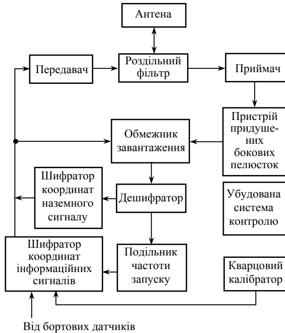
Рис. 2.5. Узагальнена схема ЛВ системи АТРСВ
