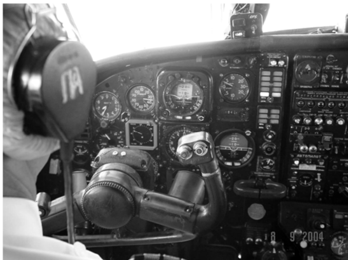
Рис. 8.31. Льотні випробування БСПЗ СПС-2000. Індикатор СПС-2000 у блакитній рамці по центру за штурвалом
