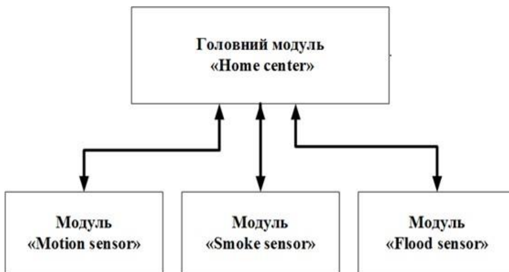
Мал. 3.11. Схема радіозв'язку між модулями системи РБ
