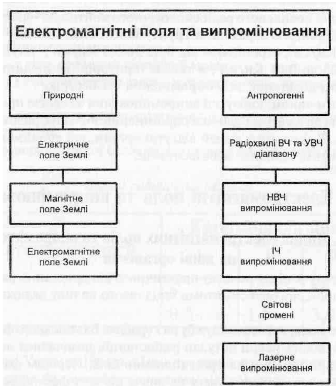
Мал. 4.1 – Види електромагнітних полів та джерел випромінювання
