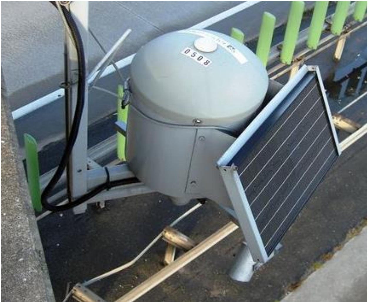
Рисунок 3.9 - Датчик заторів ( на основі джерела [49])
