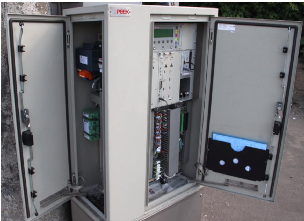
Рисунок 1.2 - Контролер розумного світлофора (на основі джерела [42])
