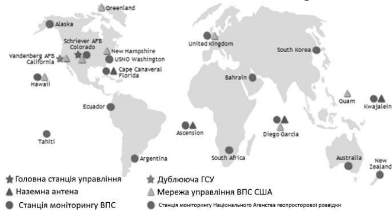
Рисунок 1.6 Розташування наземних компонентів системи навігаційної системи GPS.
