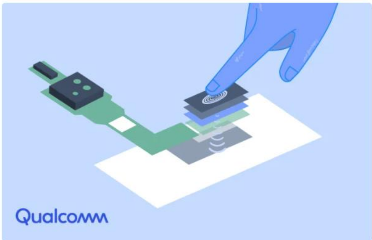
Рис 1.7. Принцип роботи ультразвукового сканера відбитків пальців
