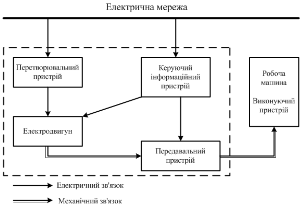
Рис. 2.1. Структурна схема автоматизованого електроприводу
