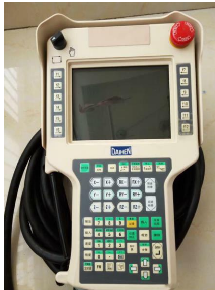
Рис. 1.3. Пульт для керування маніпулятором
