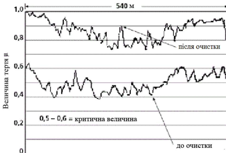
Рис. 2 Величина тертя злітно-посадкових смуг до і після водоструменевої обробки (Вимірювання: SAAB SurfaceFrictionTester)
