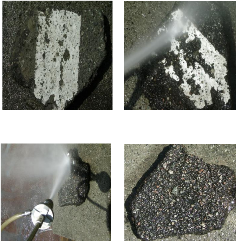
Мал.28. Поетапне зняття старої дорожньої розмітки з дослідного зразка поверхні автомобільної дороги за допомогою гідроабразивного методу
