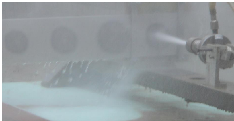
Мал.19. Процес взаємодії гідроабразивного струменя з поверхнею зразка
