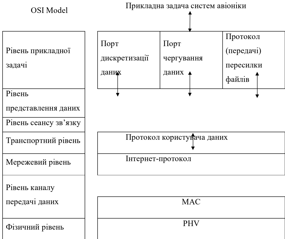
Рис.3.2.3. Архітектура протоколу кінцевої мережі AFDX.
