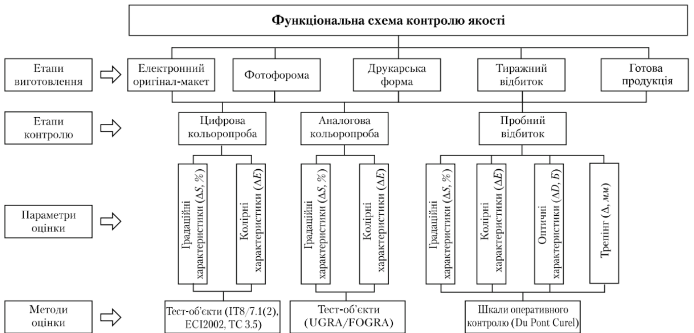
Рис. 3.2 Функціональна схема контролю якості поліграфічної продукції
