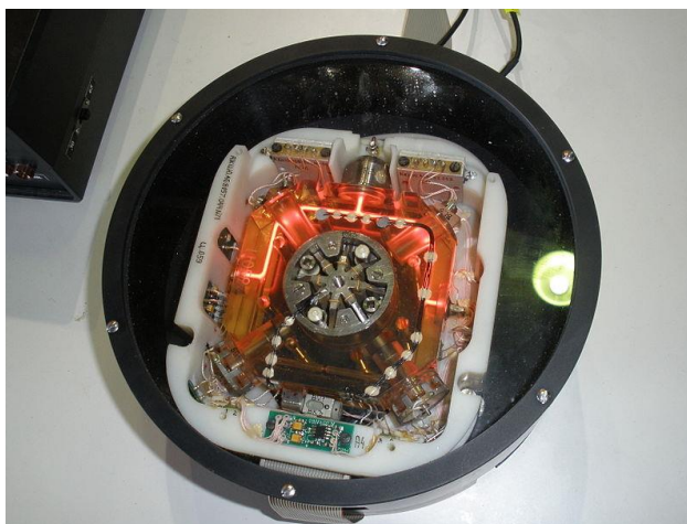
Рис.2.11. Кільцевий лазерний гіроскоп виробництва українського заводу «Арсенал» в одному з павільйонів авіасалону МАКС-2011. Резонатор має форму квадрата з дзеркалами по кутах. У його центрі розташований вібропідвіс з резонансним п'єзокерамічним збудником. Накачування здійснюється постійним струмом близько 1мА
