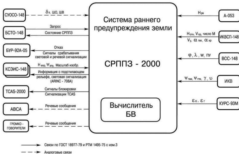
Рис. 2.1 - Структурна схема СРППЗ-2000
