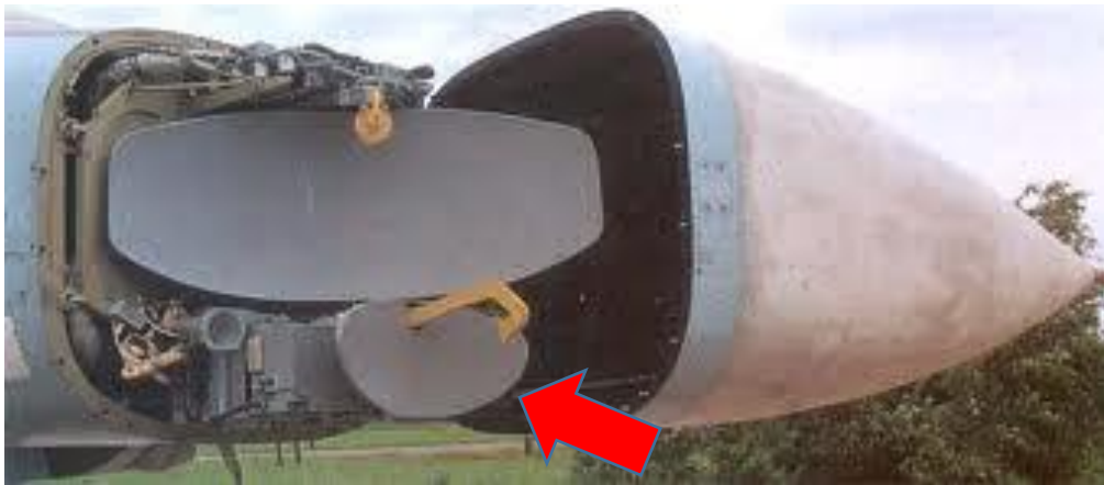
Рис. 3.9 . Радіолокатор профільного польоту «Рельєф»
