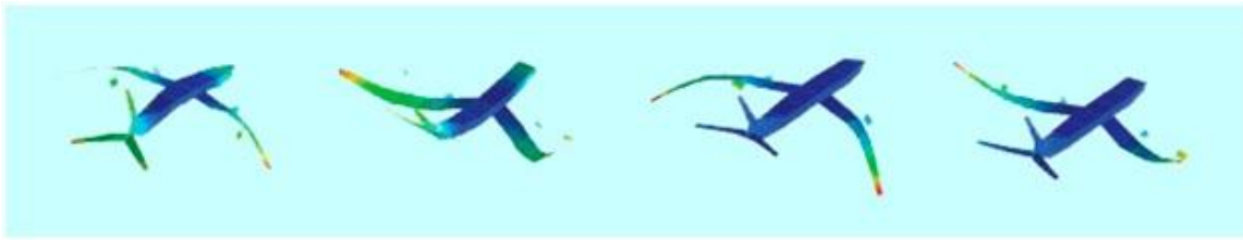
Рис.1.4 – Прояв флаттер ефекту на математичній кінцево-елементній моделі літака
