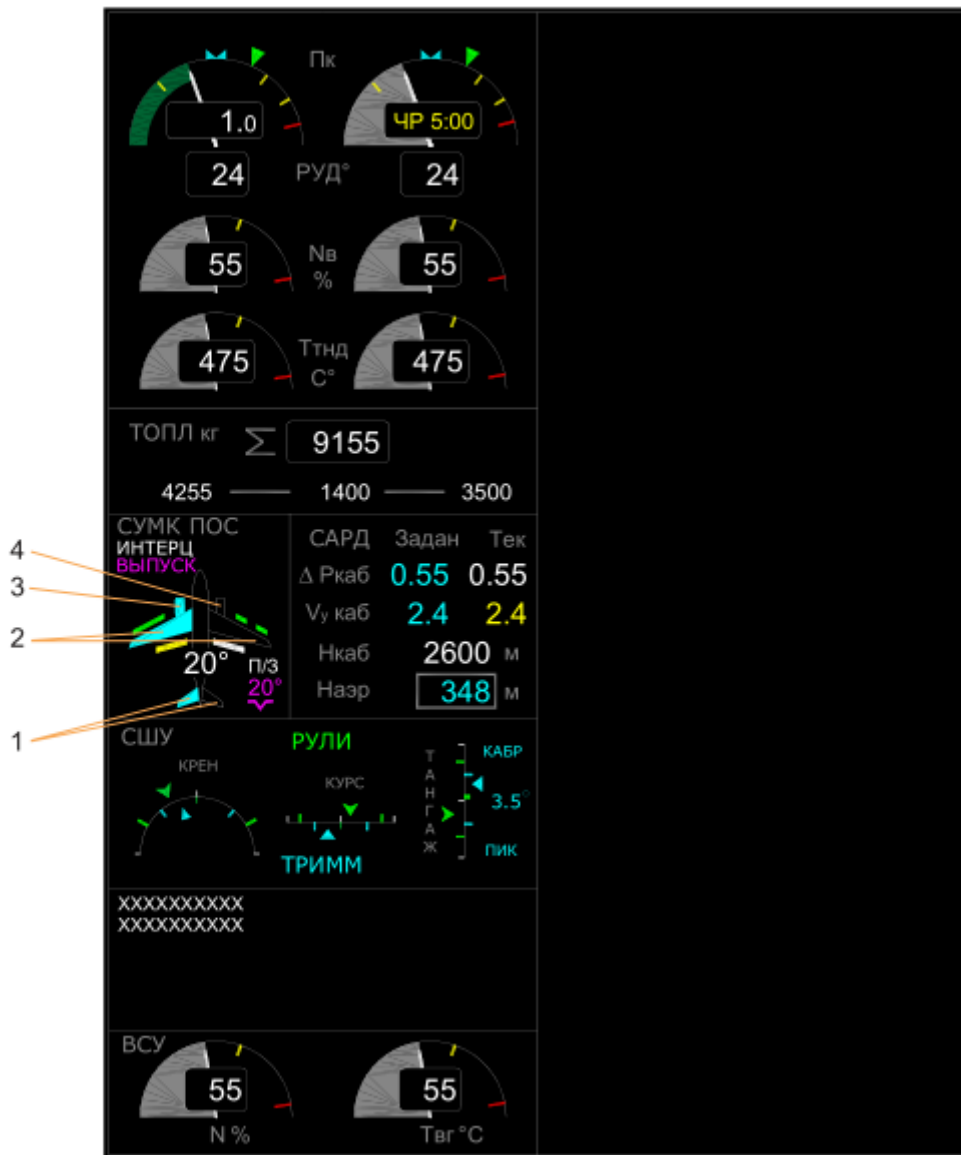
Рис. 3.4. Інформація ПОС на комплексному індикаторі систем сигналізації
