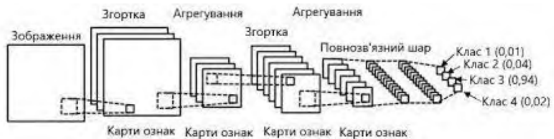
Рис. 1.5. Архітектура згорткової нейронної мережі
