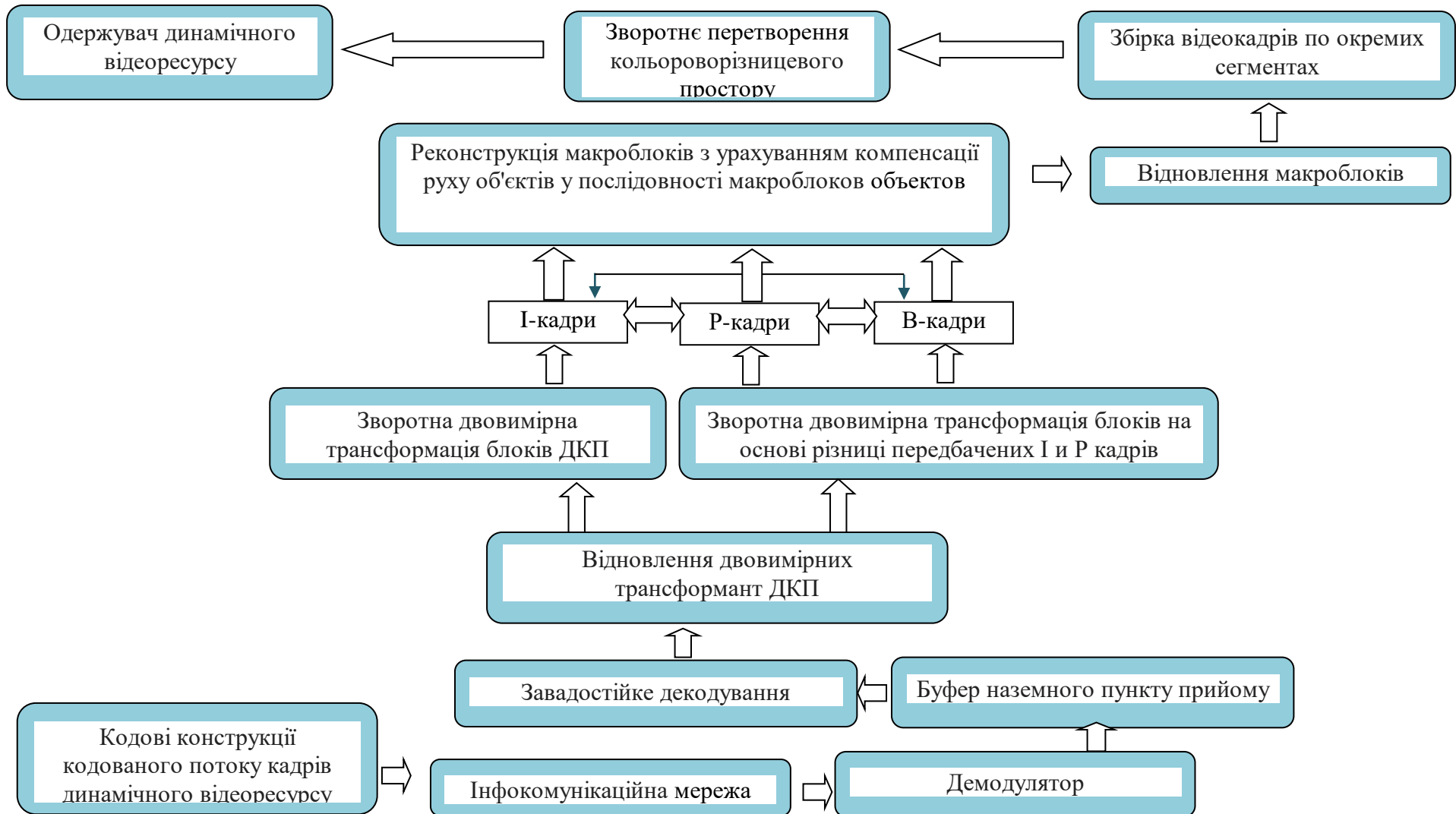
Рисунок 2.2. – Структурно-функціональна схема базових етапів інформаційної технології обробки й передачі динамічного відеоресурсу (зворотний напрямок)
