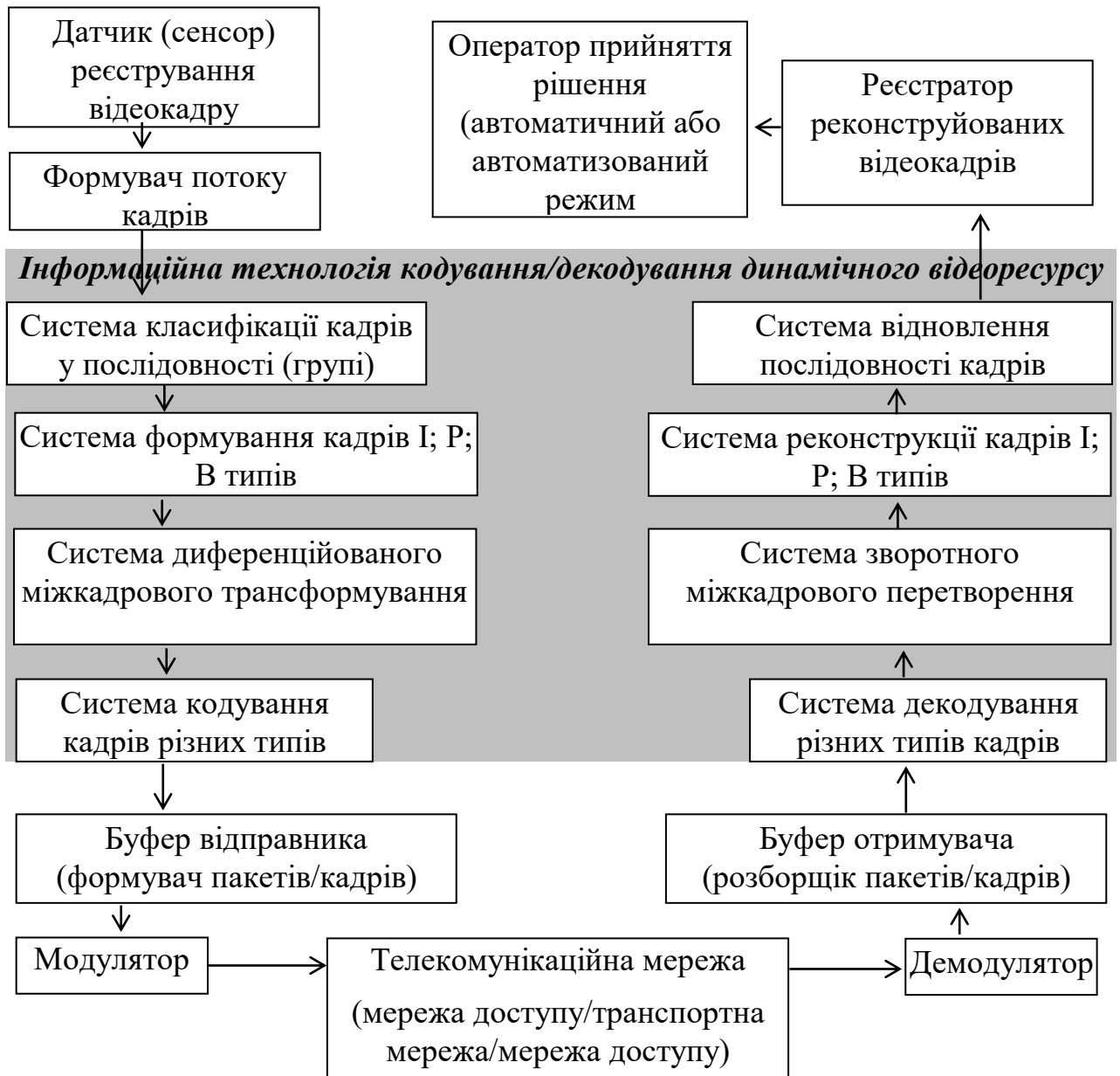
Рисунок 1.4. - Узагальнена структурно-функціональна схема концепції надання послуг ДВІР з використанням інформаційно-телекомунікаційних систем
