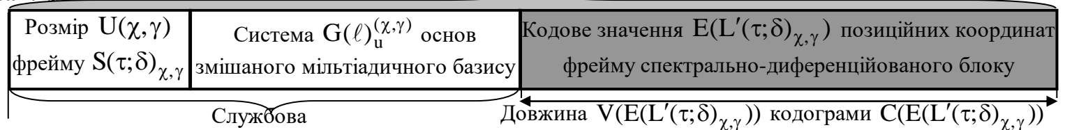
Рисунок 3.7. - Структурна схема кодової конструкції для компактно представлені послідовності В-Р кадрів
