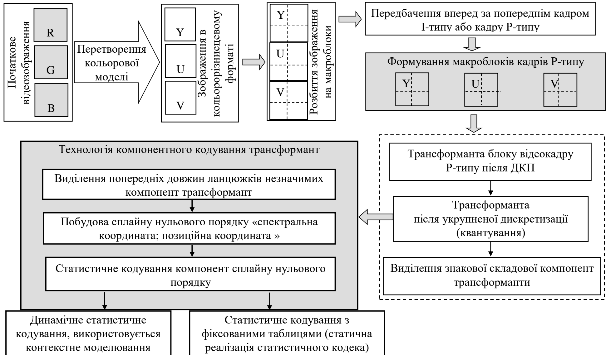
Рисунок 2.5. - Структурно-функціональна схема кодування кадрів В-Р типу для інформаційної технології обробки та передачі кадрів динамічного відеоресурсу
