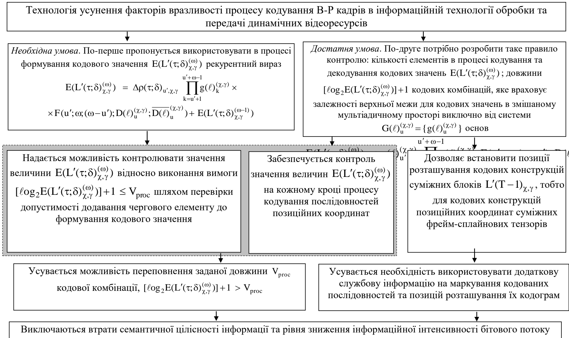
Рисунок 3.6. – Схема усунення вразливих факторів щодо втрати ефективності функціонування інформаційної технології обробки та передачі динамічного відеоресурсу
