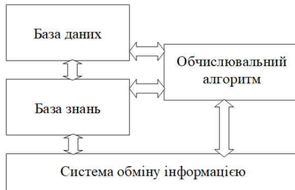
Рис. 3.3 Загальна структура інтелектуальних системи підтримки прийняття рішень
