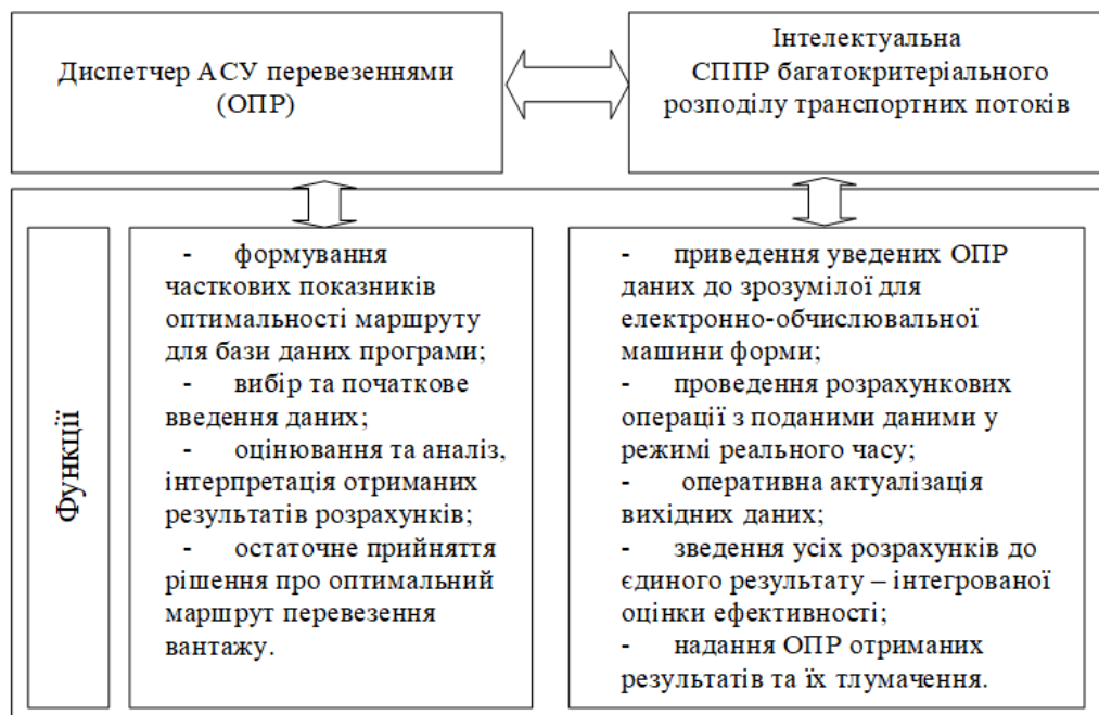
Рис. 3.2. Розподіл функцій між диспетчером АСУ та СППР багатокритеріального розподілу транспортних потоків
