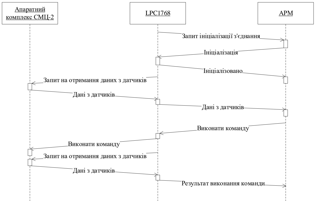
Рис. 3.7. Діаграма послідовностей комунікації через інтерфейс LPC1768
