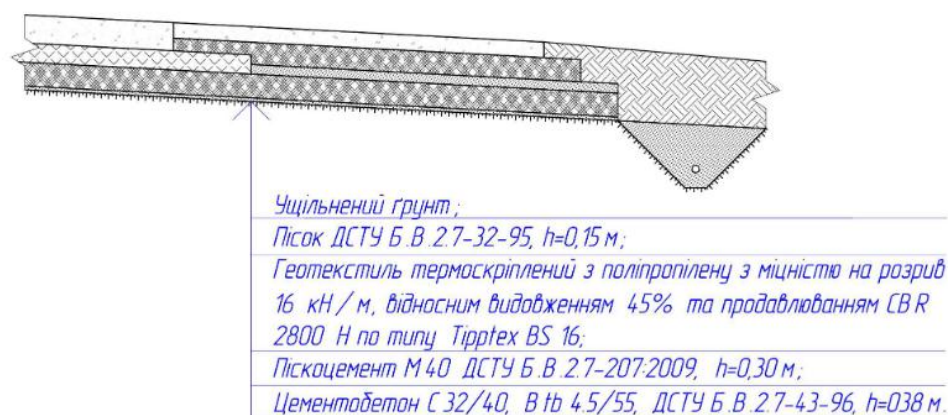
Рис. 6.2. Конструкція покриття укріплених узбіччів
