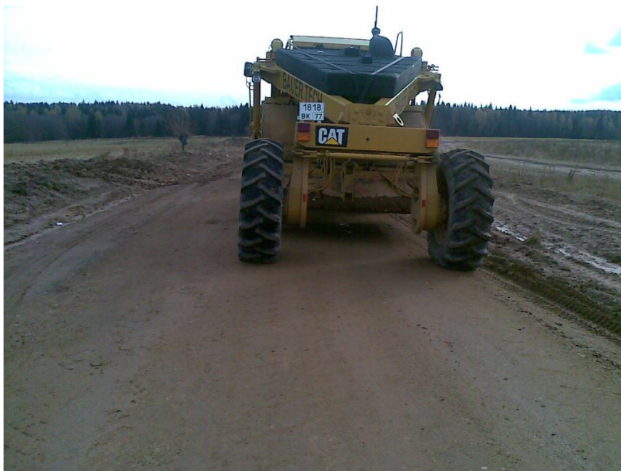
Рис. 1.5 – Машина для стабілізації ґрунтуаведені в дипломній роботі.
