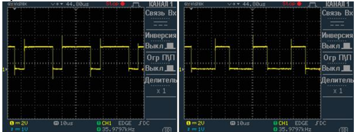
Рис. 72. Осцилограми зміни шпаруватості імпульсів ШІМ за допомогою кнопки
