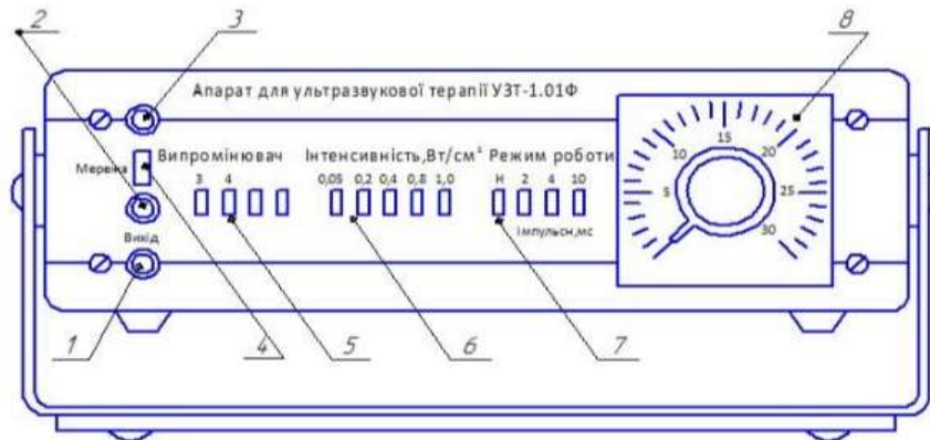
Рис. 2.3. Загальний вигляд генератора ультразвукових сигналів
