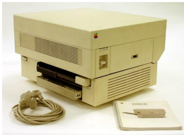
Рис. 2.1. Принтер LaserWriter від компанії Apple Computer, на якому створювалися перші видання за допомогою комп'ютерної настільних систем верстки
