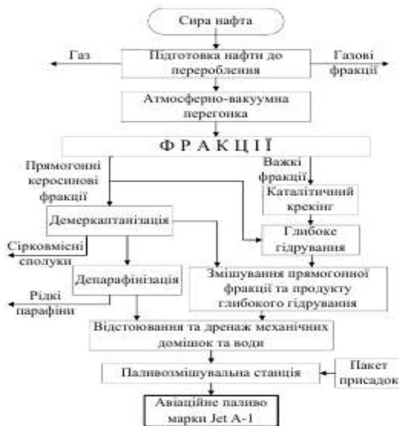
Рис.1.3. Технологічна схема виробництва палива марки Jet A-1
