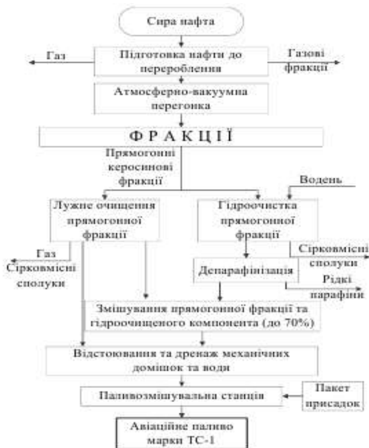
Рис. 1.1. Технологічна схема виробництва палива марки ТС-1
