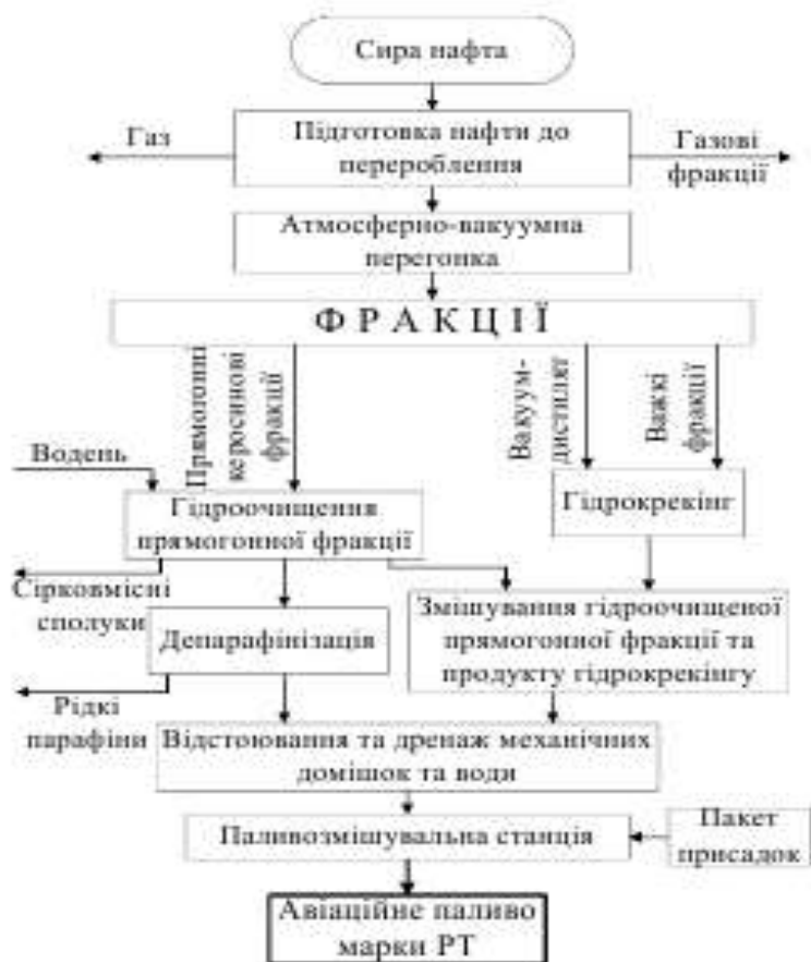
Рис.1.2. Технологічна схема виробництва палива марки RT
