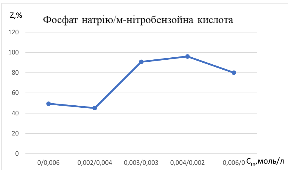
Рис. 3.7. Графік залежності ступеню захисту при корозії сталі від співвідношення концентрацій фосфату натрію та м-нітробензойної кислоти, за їх загальної концентрації 0,006 моль/дм 3 .
