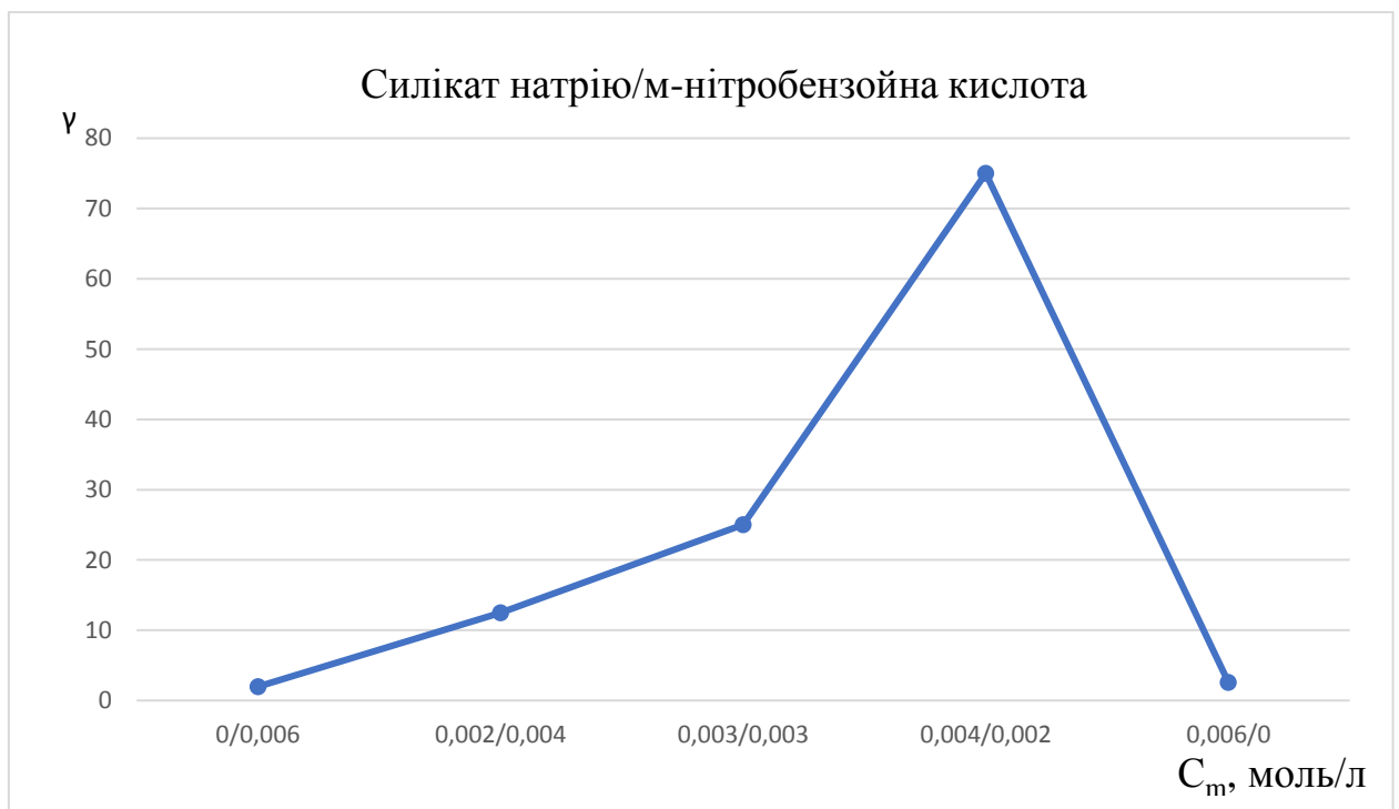
Рис. 3.4. Графік залежності коефіцієнту гальмування корозії сталі від співвідношення концентрацій силікату натрію та м-нітробензойної кислоти, за їх загальної концентрації 0,006 моль/дм 3 .
