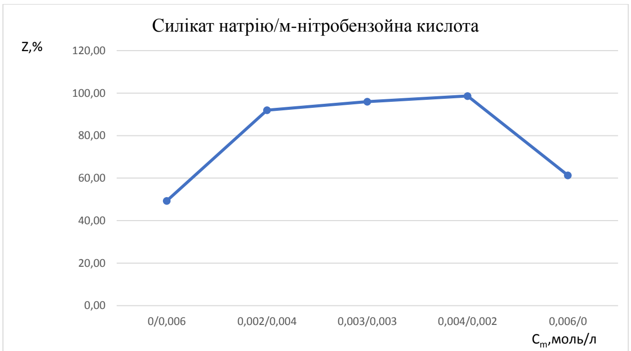
Рис. 3.5. Графік залежності ступеню захисту при корозії сталі від співвідношення концентрацій силікату натрію та м-нітробензойної кислоти, за їх загальної концентрації 0,006 моль/дм 3 .
