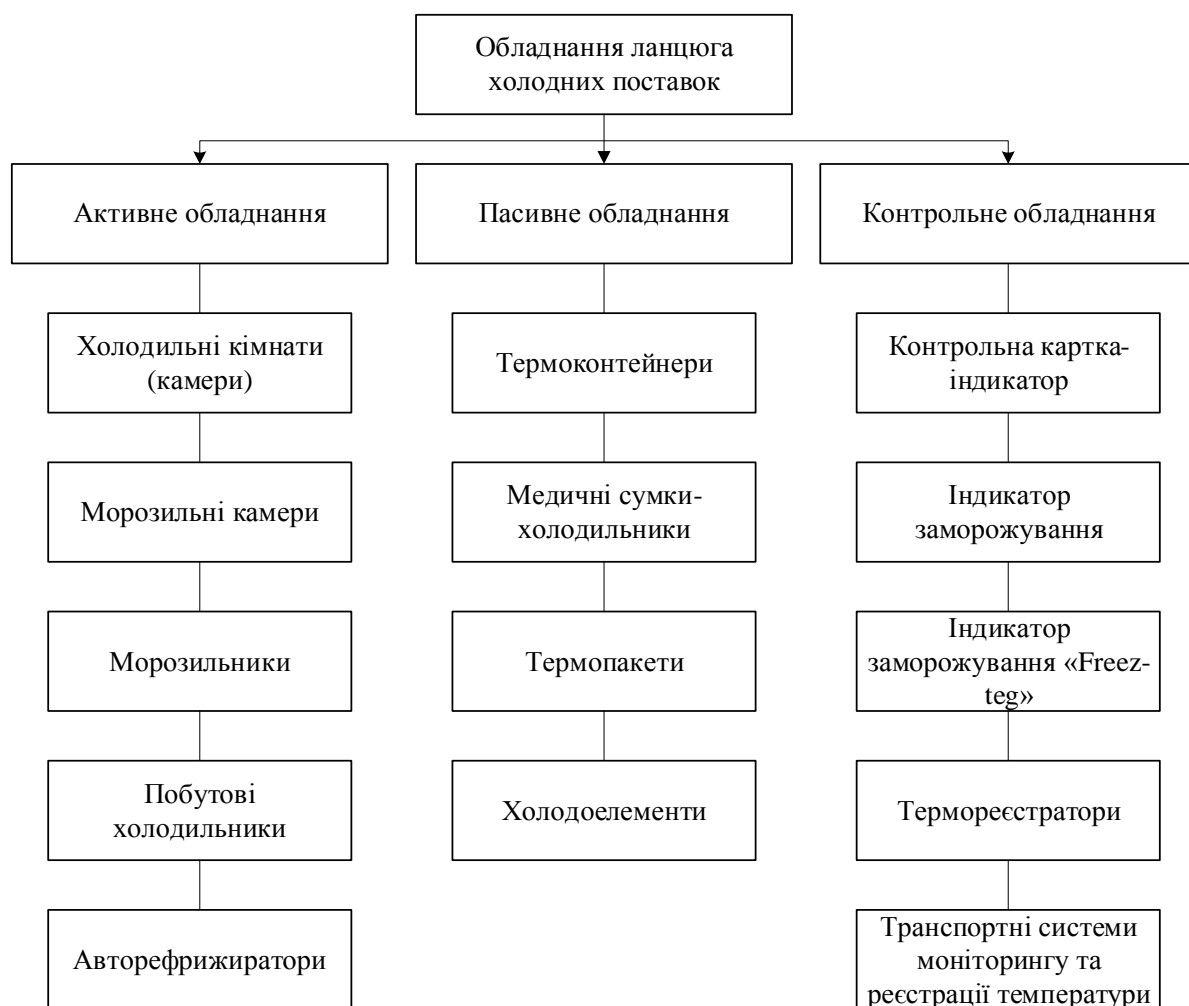
Рисунок 1.2 – Обладнання ланцюга холодних поставок
