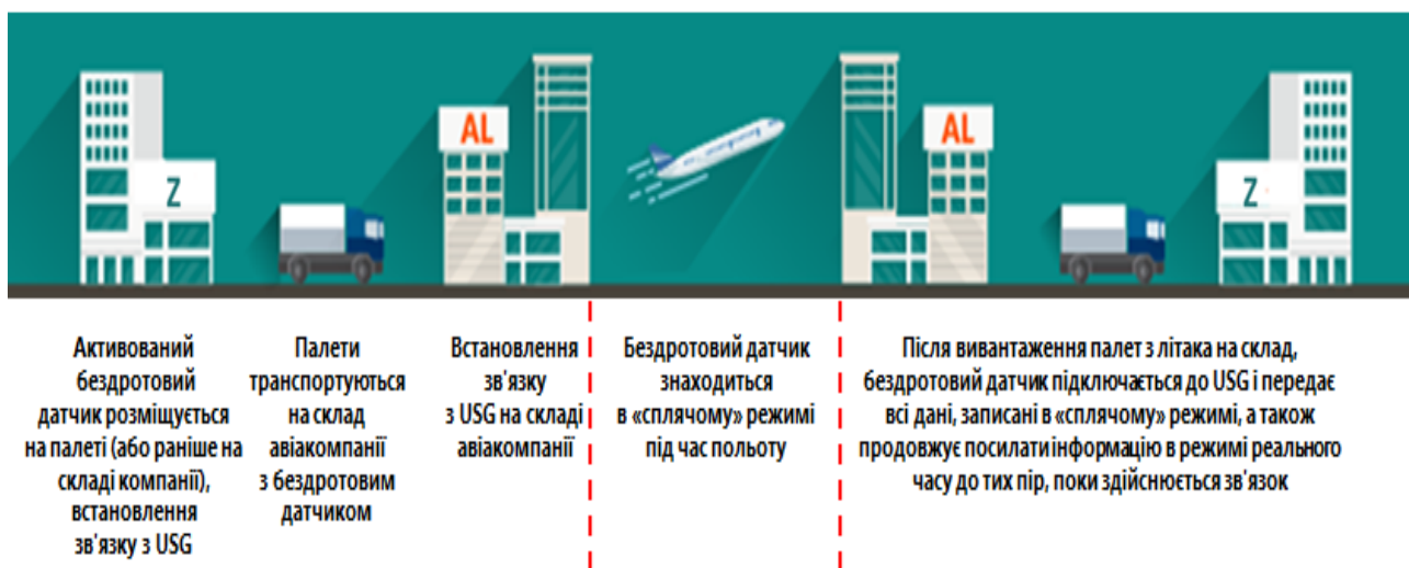
Рис. 1.1 - Процес запису даних температури та вологості медичних препаратів
