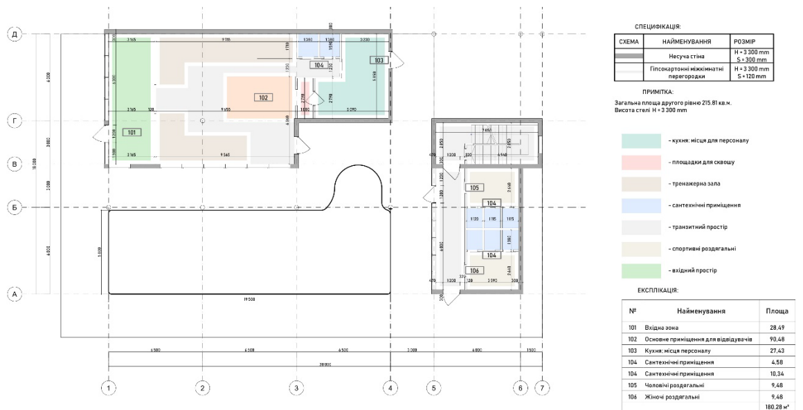
Рис. 3.3. Схема функціонального зонування першого рівню споруди
