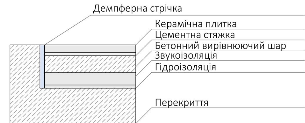
Вузол укладання плитки
